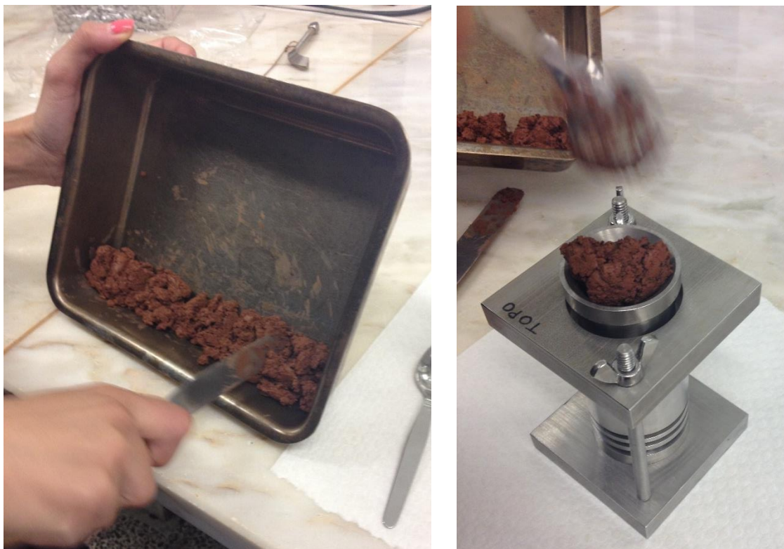
Figura 4.9 - À esquerda, cordão de solo a dividir em porções equivalentes ao número de camadas. À direita, solo introduzido dentro do molde.
