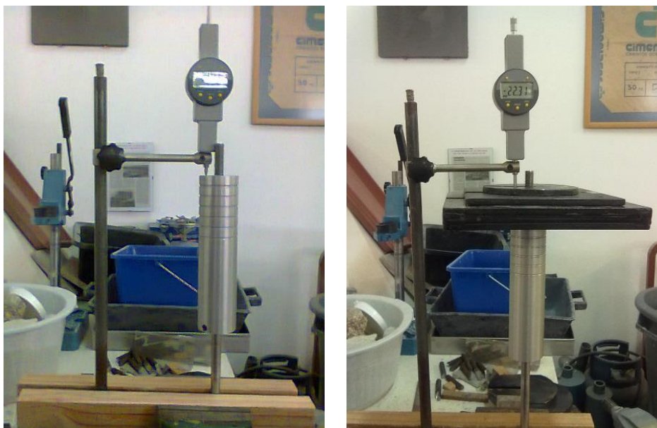
Figura 4.28 - Esquerda: Leitura indireta da deformação das molas em laboratório. Direita: Pormenor dos pesos acima do martelo.
