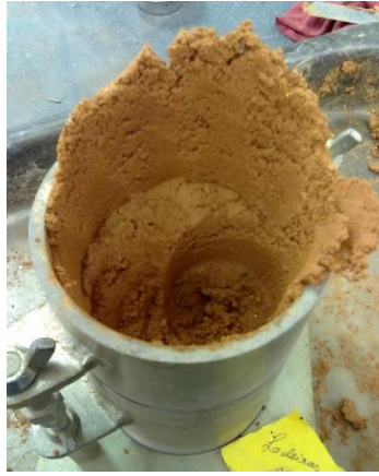
Figura 5.4 - "Cortina" de solo em torno das paredes do molde em consequência de um elevado teor em água.
