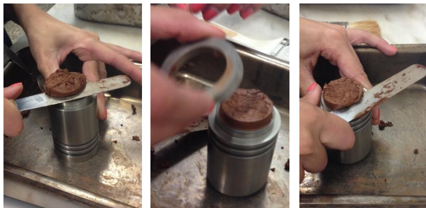
Figura 4.13 - Acabamentos dos tops da amostra.
