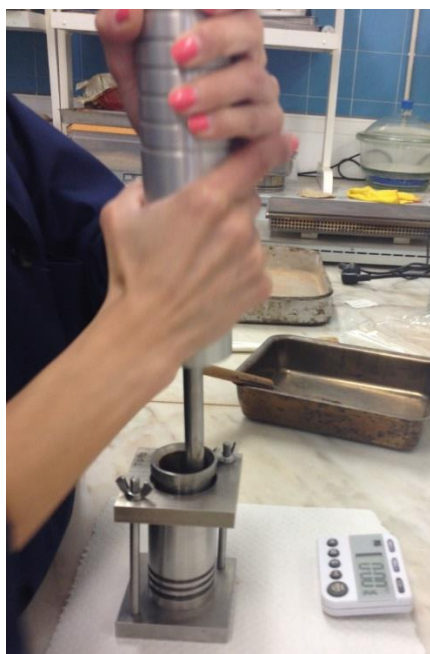
Figura 4.10 - Compactação do solo com o martelo de Harvard. Pormenor da verticalidade que é necessária manter.
