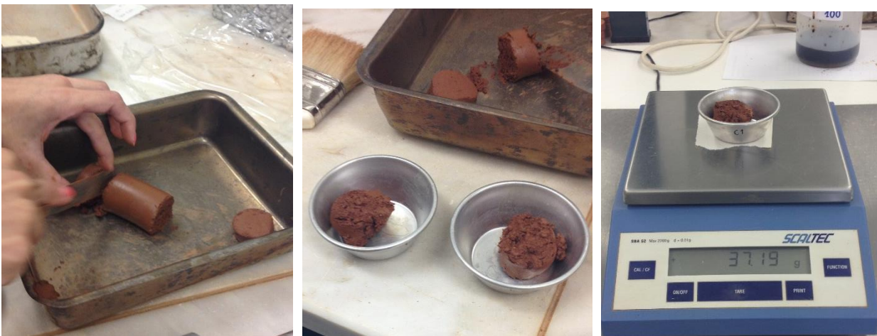
Figura 4.18 - Em primeiro, corte do solo nas frações mencionadas. Seguidamente, colocação das amostras em cápsulas e pesagem das mesmas.
