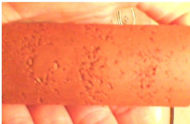
Figura 5.7 - Acabamento da superfície lateral da amostra compactada com a mola de 20 lb com 30 pressões.
