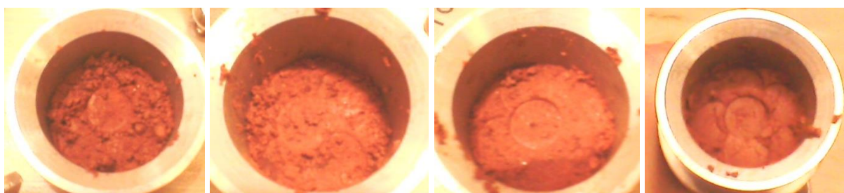
Figura 5.6 - Superfície da amostra compactada com a mola de 20 lb com 10 pressões em 15 segundos, 20 pressões em 30 segundos, 30 pressões em 45 segundos, 40 pressões em 60 segundos.
