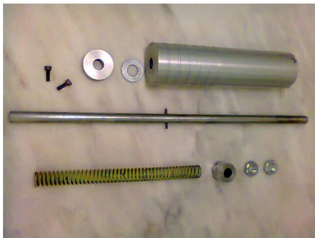
Figura 4.2 - Acessórios que integram o martelo.
