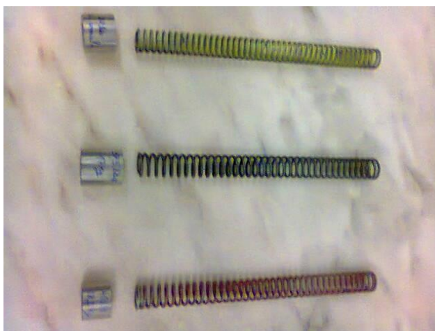
Figura 4.3 - Molas existentes com respetivo espaçador. Mola de 20 lb a amarelo, mola de 37,5 lb a cinzento e mola de 40 lb a vermelho.
