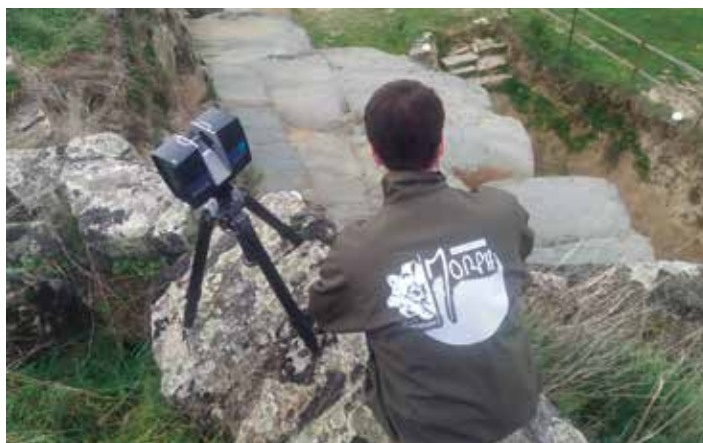
Fig. 19: Aspecto dos trabalhos de varrimento TLS realizados no sítio arqueológico da Penascosa. Nesta fotografia, o sector da escavação de 2018, junto da rocha 38. Foto de Miguel Almeida.
