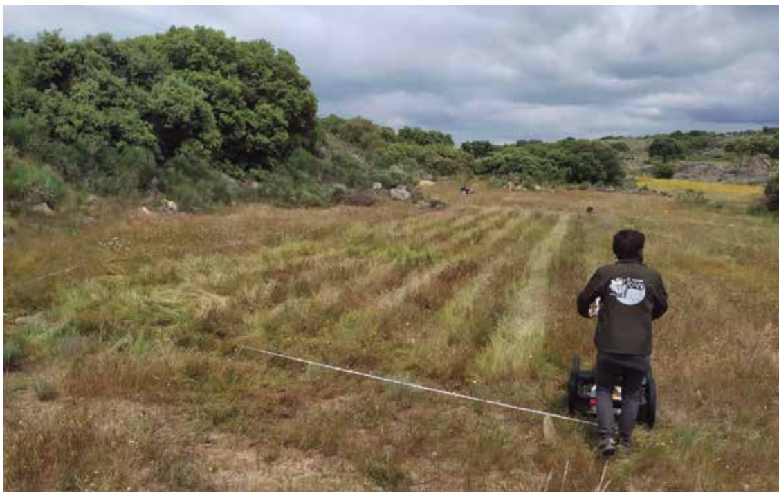
Fig. 28: Aspecto dos trabalhos de prospecção de georadar realizados no sítio arqueológico da Olga Grande 14: notar a localização do polígono de aquisição e marcas das passagens paralelas da antena. Foto de Miguel Almeida.
