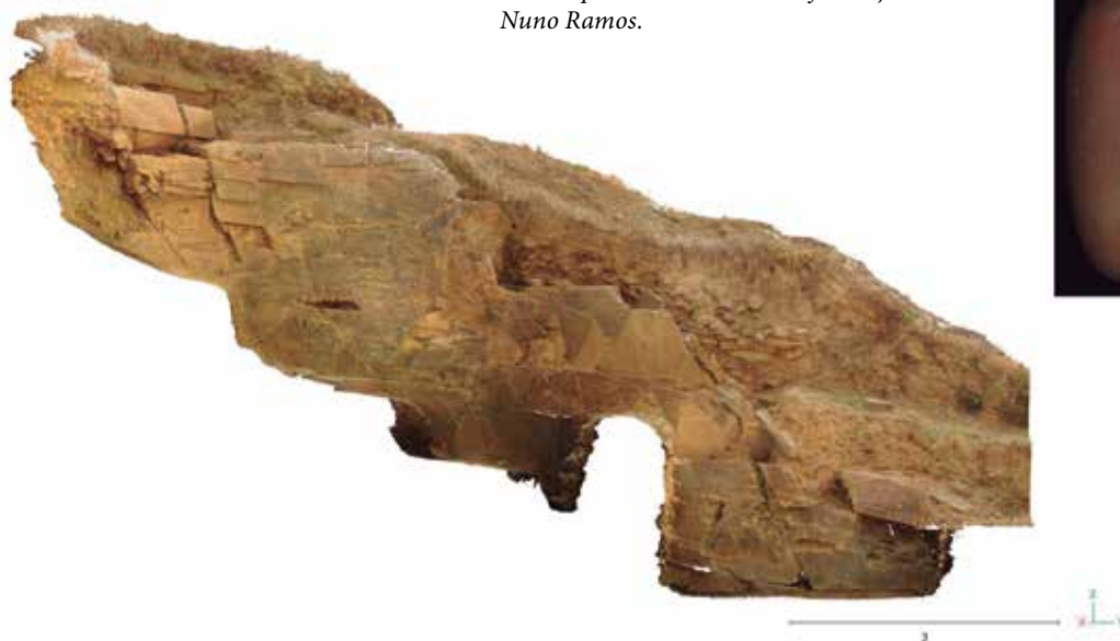
Fig. 16: Nuvem de pontos resultante de digitalização 3D com laser scanner da Rocha 9 do Fariseu (10/05/2022). Este modelo global da rocha com precisão de 2mm serve de base geométrica para a integração de modelos fotogramétricos mais precisos (cfr. fig. 13). Modelo de Nuno Ramos.
