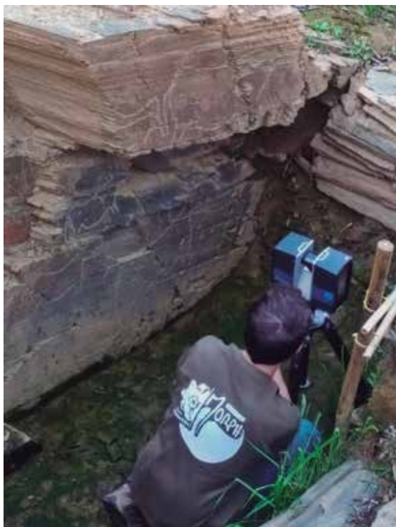
Fig. 9: Realização de levantamento com laser scanner terrestre (Rocha 9 do Fariseu). Foto de Miguel Almeida.
