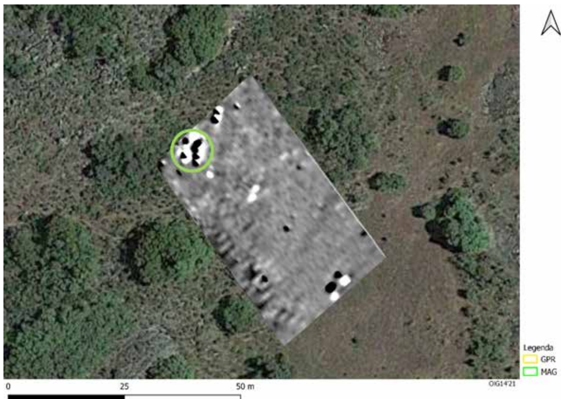
Fig. 30: Projecção do mapa de gradiometria magnética sobre ortofotomapa (©Google Earth, 2021-05-24), com representação a verde de uma anomalia magnética de elevado contraste. Infografia de André Ferreira.
