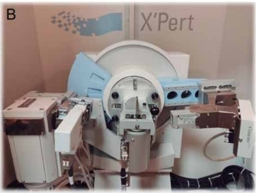
Fig. 6: Equipamento de análise de DRX: estrutura externa (A); estrutura interna (B) ( http://ume.utad.pt/DRX.html ).
