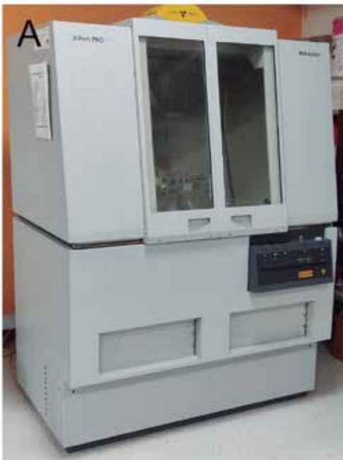
Fig. 6: Equipamento de análise de DRX: estrutura externa (A); estrutura interna (B) ( http://ume.utad.pt/DRX.html ).
