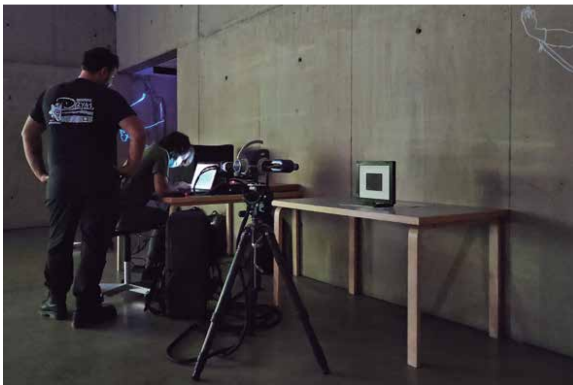
Fig. 12: Digitalização de arte móvel por fotogrametria de luz estruturada (Museu do Côa, 08/08/2022). Foto de Miguel Almeida.
