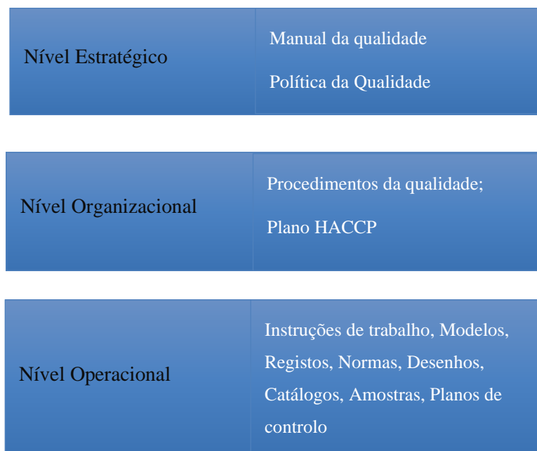
Figura 2.5 - Diagrama representativo dos níveis de documentação relativa ao SGQ da Fábrica Pastelaria São Silvestre, Lda. Adaptado de (Costa, 2016).
