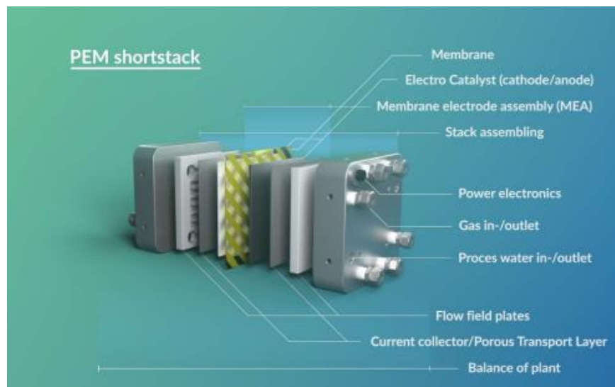
Figura 8 - Constituição de um eletrolisador de membrana de troca de protões [25]
