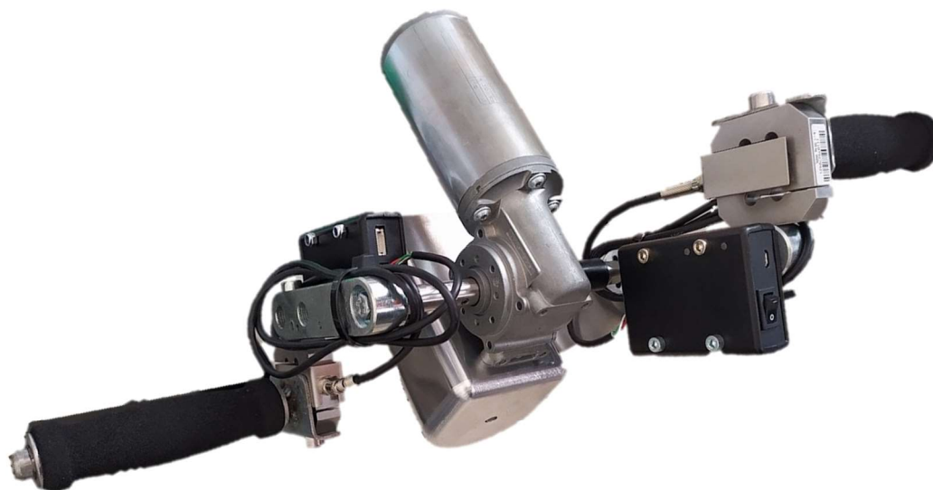
Figura 6.9 – Módulo rotativo com instrumentação desenvolvida pela Wiseware.
