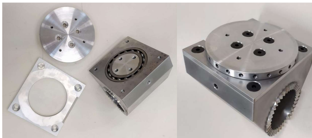
Figura 5.2 – Mecanismo de acoplamento da guia linear em AL7075.
