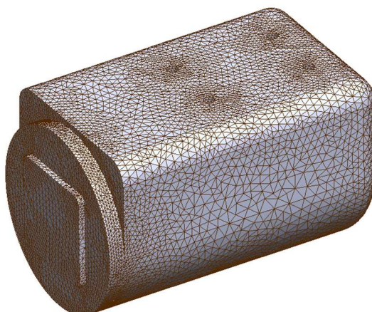
Figura 4.25 – Vista geral do aspeto da malha utilizada no estudo do subsistema rotativo.
