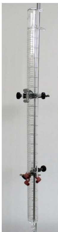
Figura 17 - Bureta segundo a norma ASTM D2699
