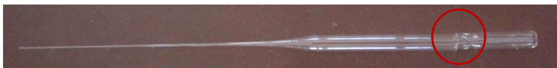
Figura 42 – Pipeta de Pasteur defeituosa
