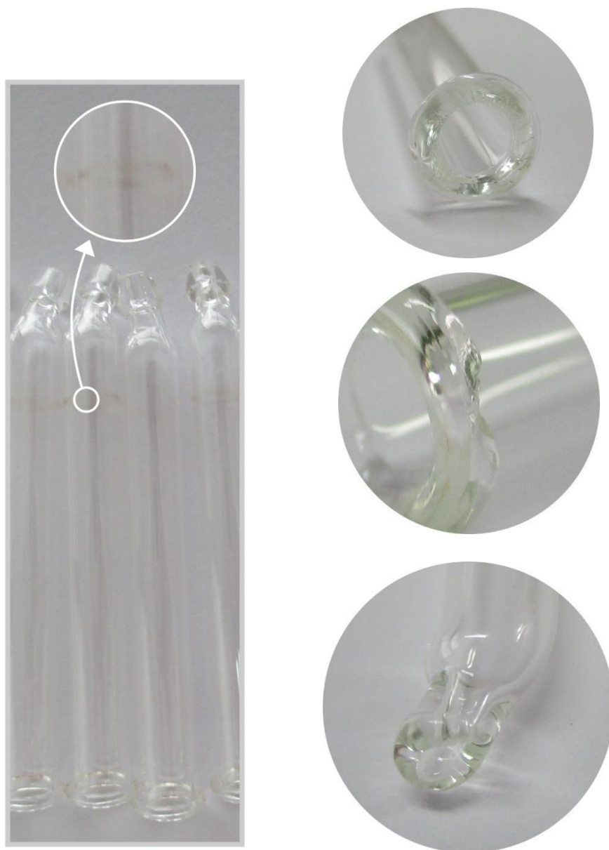
Figura 24 – Fotografias de alguns dos defeitos de PCG
