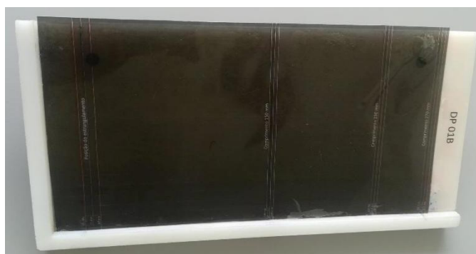
Figura 39 – Bitola criada para inspeção pipetas de Pasteur
