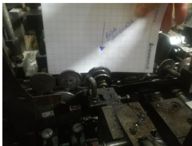
Figura 28 – Roda borracha degradada
