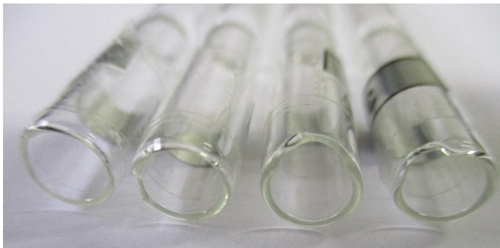
Figura 41 – Pipetas de Pasteur com deformações no topo
