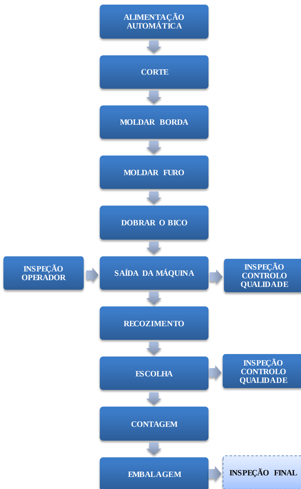
Figura 22 – Fluxograma processo de fabrico PCG
