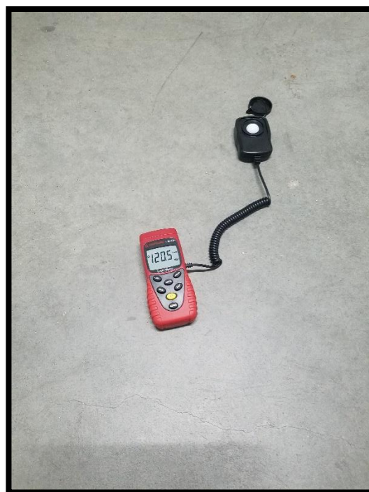
Figura 28: Luxômetro digital Fluke LM-120 usado nas medições (Fonte: Autor)
