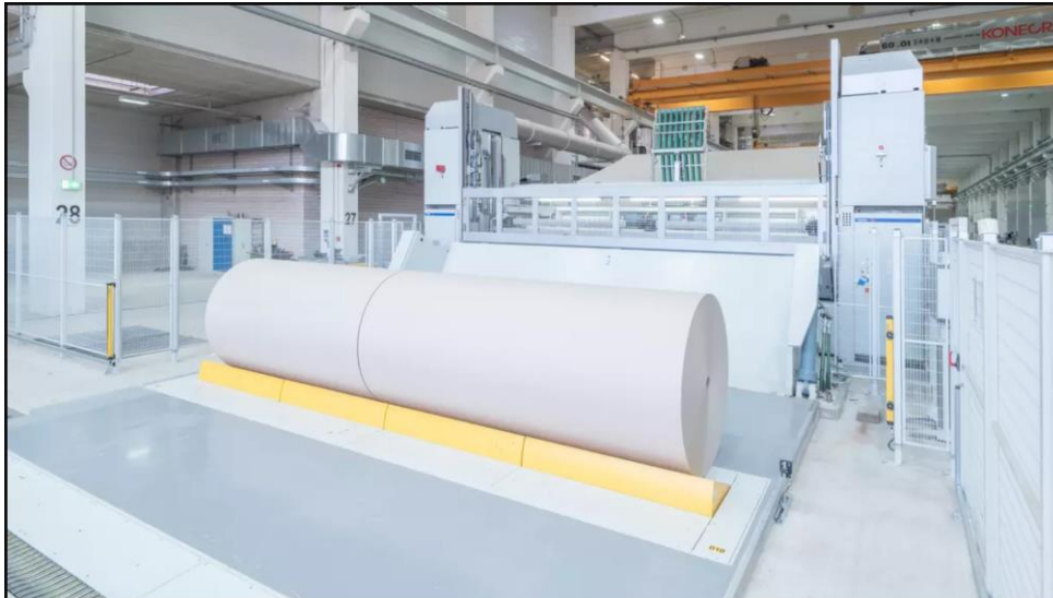
Figura 5.3 – Vistas de uma bobinadora de papel a) aérea e b) frontal, na estação de descarregamento de bobinas 1
