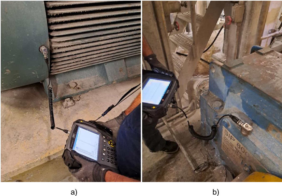
Figura 6.3 - Medidas de vibração efetuadas em: a) um motor elétrico; e b) uma caixa redutora
