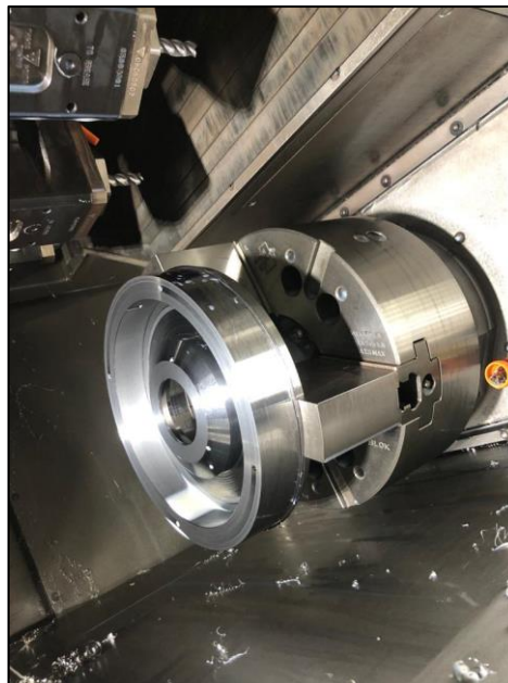
Figura 85: Maquinação do segundo lado concluída
