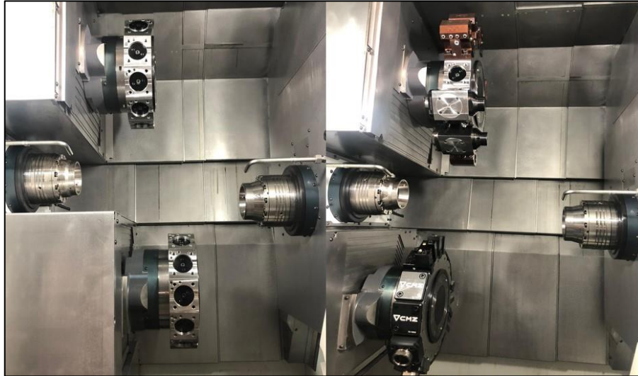
Figura 105: Máquina antes e depois da montagem dos suportes de ferramenta nas torretas
