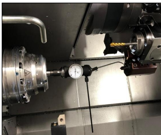
Figura 108: Alinhamento de ferramentas com recurso a dispositivo comparador
