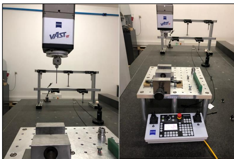
Figura 24: Probe e mesa com acessórios de fixação da máquina Zeiss Accura II
