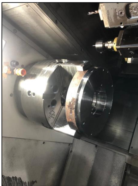
Figura 81: Maquinação do primeiro lado concluída
