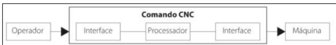
Figura 29: Implementação do CNC, (adaptado de (Relvas, 2018))
