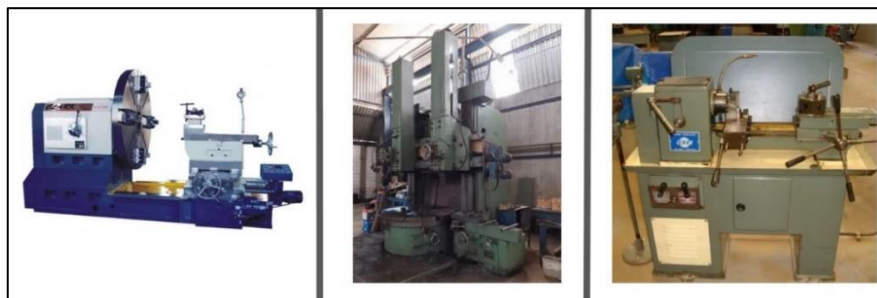
Figura 27: Torno de placa, vertical e de revólver, respetivamente, (adaptado de (RML, 2020))
