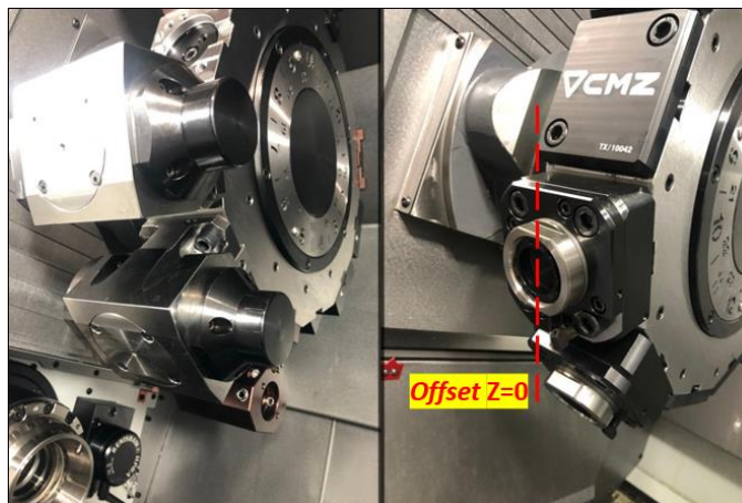
Figura 107: Suportes motorizados axial (à esq.), radial (à dir.) e ilustração do offset Z=0
