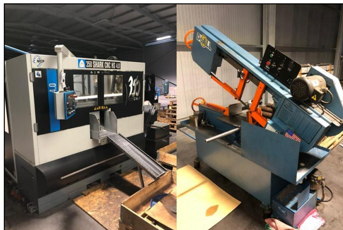
Figura 7: Serrote CNC e serrote mecânico
