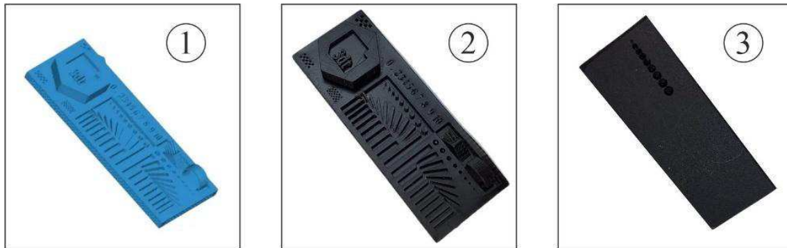
Figura 8. Calibrador técnico para ajuste de parâmetros de impressão. (1) Representação digital do ficheiro STL do calibrador, disponível em impressao3dresina.com.br ; (2) vista superior da peça impressa após calibração inicial; (3) vista inferior da mesma peça, evidenciando os elementos de controlo geométrico.
