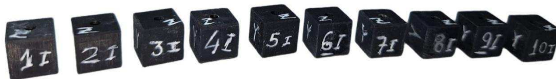
Figura 10b. Cubos do grupo da impressora industrial numerados de 1I a 10I. Vista em perspectiva das amostras numeradas sequencialmente com marcador branco, correspondentes ao grupo impresso na Anycubic Photon M3 Max. As faces Z (com orifício passante) e Y foram mantidas a mesma orientação em todas as peças, assegurando consistência espacial para as medições.
