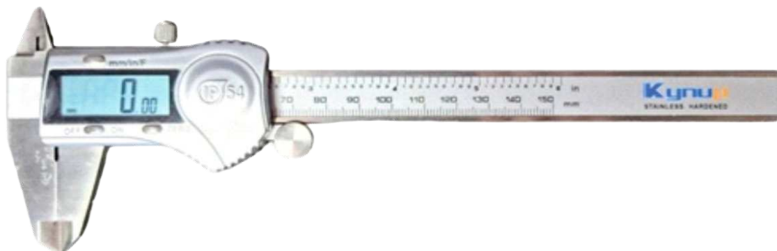
Figura 5. Paquímetro digital Kynup CE/FCC utilizado para as medições dimensionais das amostras. O instrumento apresenta resolução de 0,01 mm e precisão de \pm 0,02 mm, operando por sistema capacitivo linear.
