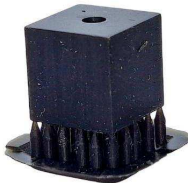
Figura 9. Cubo-padrão impresso com suportes gerados automaticamente. Modelo tridimensional com 10 mm de aresta, orientado com a face perfurada perpendicular à plataforma de impressão, permitindo a identificação directa do eixo Z. Os suportes foram aplicados sobre essa face, conforme configuração definida no software CHITUBOX_Basic.
