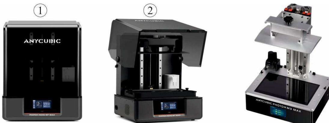
Figura 3. Vista frontal (1), vista com a tampa superior aberta (2) e detalhe da plataforma de impressão (3) da impressora Anycubic Photon M3 Max®. Este modelo apresenta estrutura em alumínio anodizado, plataforma com superfície texturizada para otimizar a adesão da peça e ecrã LCD monocromático de alta resolução, compatível com resinas fotopolimerizáveis.
