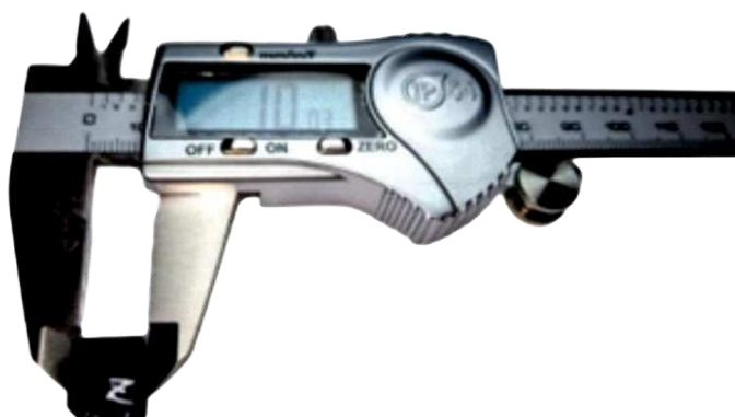
Figura 12. Procedimento de medição dimensional com o paquímetro digital Kynup CE/FCC. Vista superior do posicionamento do instrumento em contacto com a face Y do cubo, durante a leitura do ponto “Meio”. Tanto o cubo como o paquímetro foram mantidos apoiados sobre superfície plana para garantir estabilidade dimensional.
