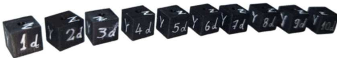
Figura 10a. Cubos do grupo da impressora dentária numerados de 1d a 10d. Vista em perspectiva das amostras numeradas sequencialmente com marcador branco, correspondentes ao grupo impresso na Zirkonzahn P4000. As faces Z (com orifício passante) e Y foram mantidas a mesma orientação em todas as peças, assegurando consistência espacial para as medições.
