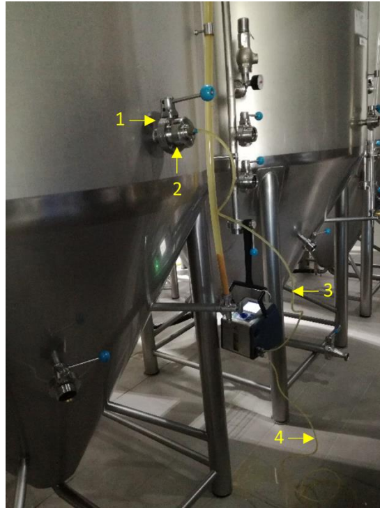
Figura 16 - Esquema de montagem do medidor de OD à cuba de fermentação (1 - torneira/passador superior; 2 - adaptador de inox; 3 - tubo de entrada; 4 - tubo de descarte).
