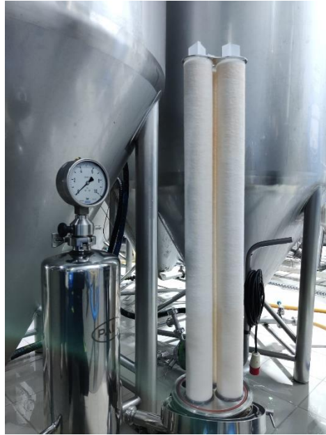
Figura 8 - Sistema de housing com 3 cartuchos utilizado na empresa.
