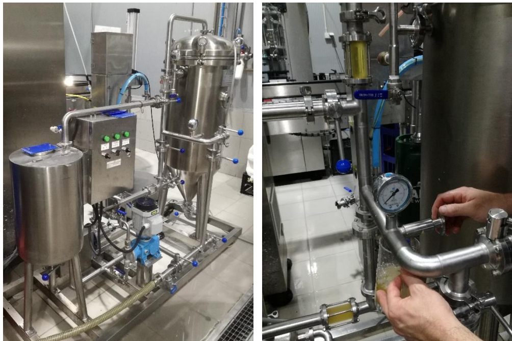
Figura 10 - Filtro de terras diatomáceas da empresa (esquerda); Recolha da amostra de cerveja filtrada para análise dos parâmetros de turbidez e °Brix (direita).
