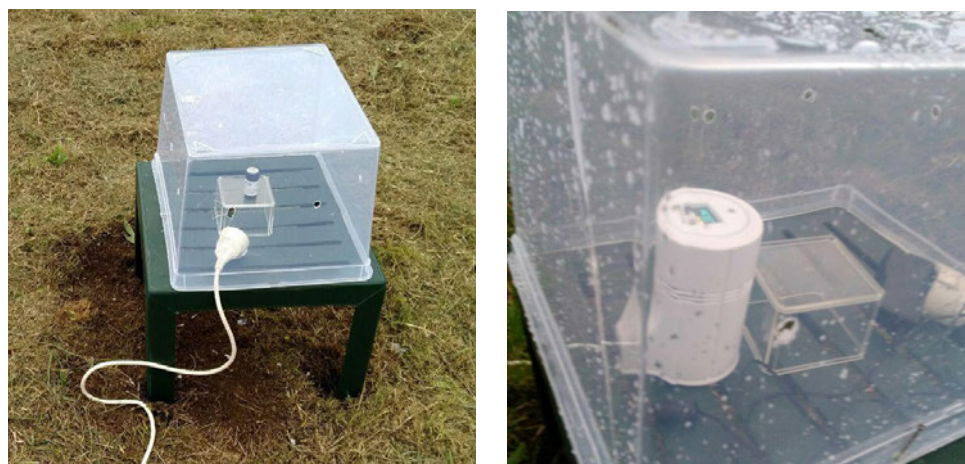
Fig. 65 - Estación de control y dispositivo de medida RadonEye.
