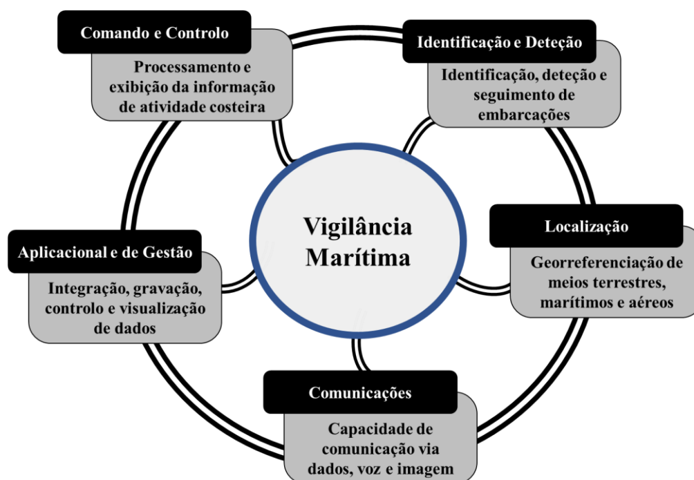
Figura 2 - Funcionamento dos Subsistemas do SIVICC
