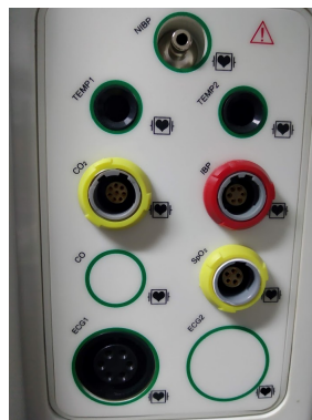
Figura 3.1: Parâmetros de medição de um Monitor de Sinais Vitais.
