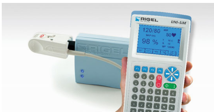
Figura 2.5: Simulador Rigel UNI-SIM com o PULS-R.
