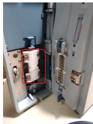
(b) Peça partida de Bomba de Perfusão volumétrica.
