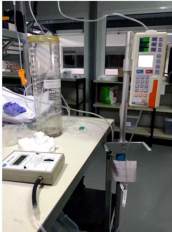
Figura 3.18: Medição da pressão de oclusão numa Bomba de Perfusão.
