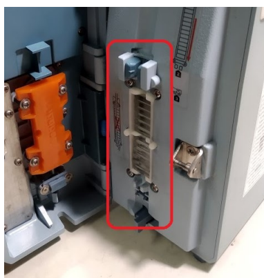
Figura 3.15: Bomba de Perfusão Volumétrica - Mecanismo com movimentos peristálticos.
