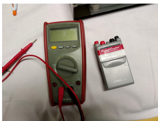
Figura 3.47: Multímetro digital e equipamento com resistência interna.
