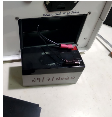
(c) Bateria conectada no ventilador com os terminais novos.
