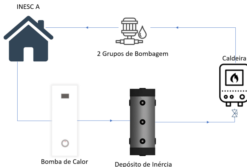
Figura 22 – Esquema simplificado de funcionamento da instalação de calor no INESC A
