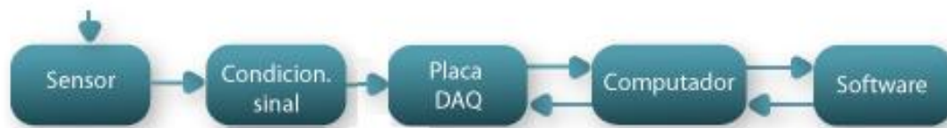
Figura 2.12 - Dinamómetro multicanal digital. Diagrama de blocos funcionais.
