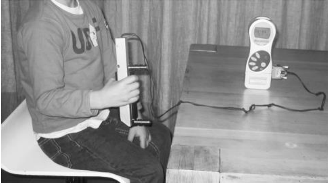
Figura 2.13 - Dinamómetro Lode operado por uma criança.
