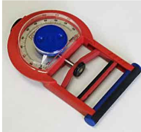
Figura 2.7 - Dinamómetro a mola Smedley.
