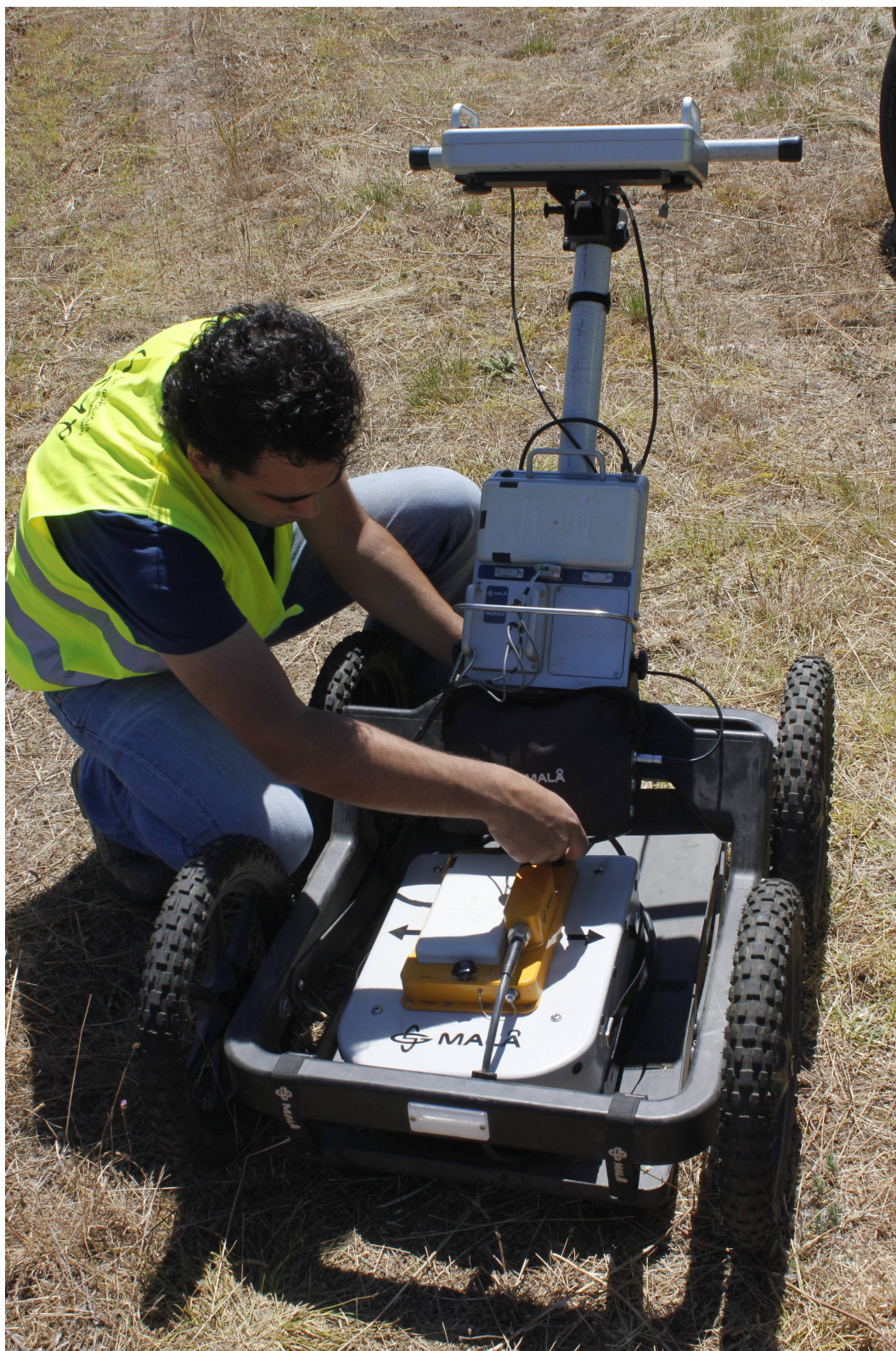
Figura 1: Montagem do Georadar com a antena de 500MHz na configuração de carrinho com odômetro.
