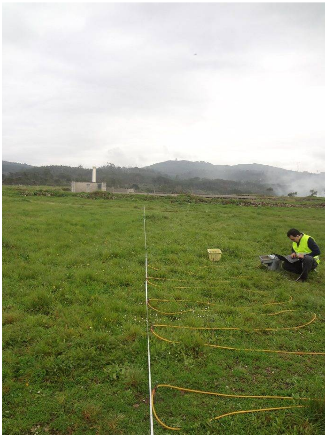
Figura 5: Aspecto da instalação do equipamento de resistividade eléctrica.
