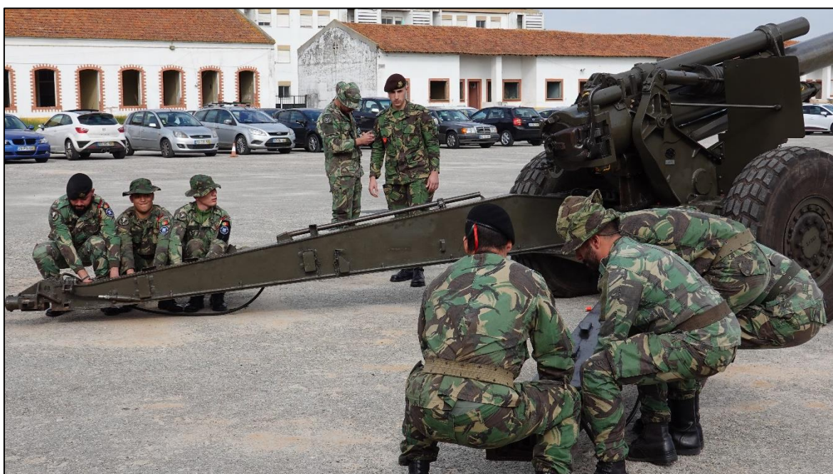
Figura nº 16 - Colocação do aparelho de pontaria à vertical da estaca
