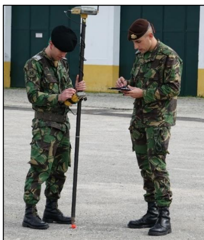
Figura nº 13 – Levantamento da posição do aparelho de pontaria
