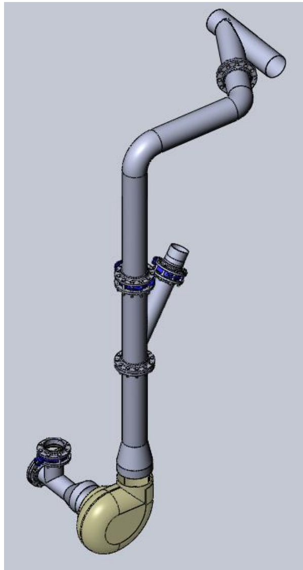
Figura 54 - montagem geral da tubagem de exaustão
