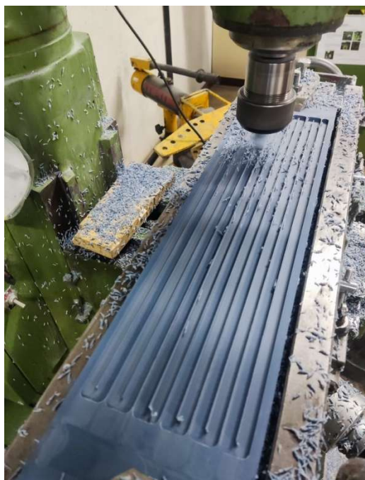
Figura 3.16 – Maquinação de coletor solar em poliuretano com múltiplas passagens.
