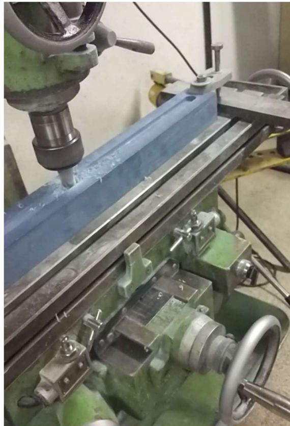
Figura 3.5 – Maquinação do canal de escoamento.
