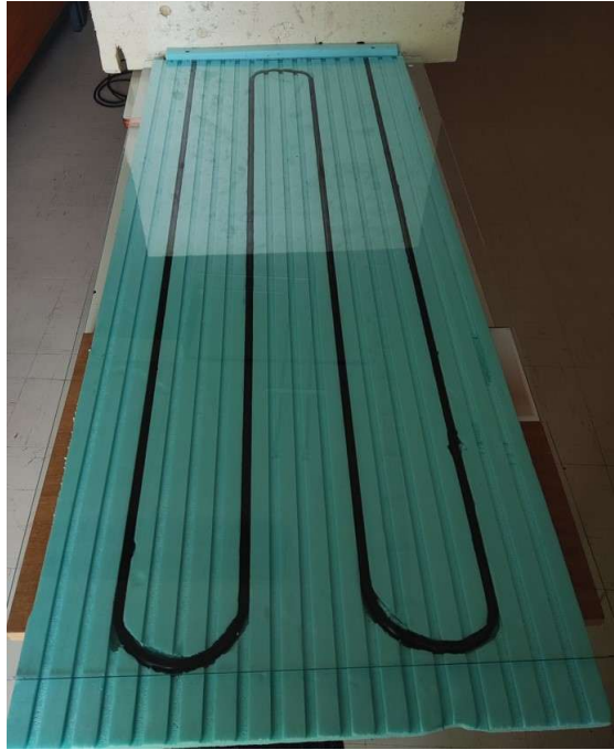
Figura 3.14 – Coletor solar em mangueira com cobertura de vidro.
