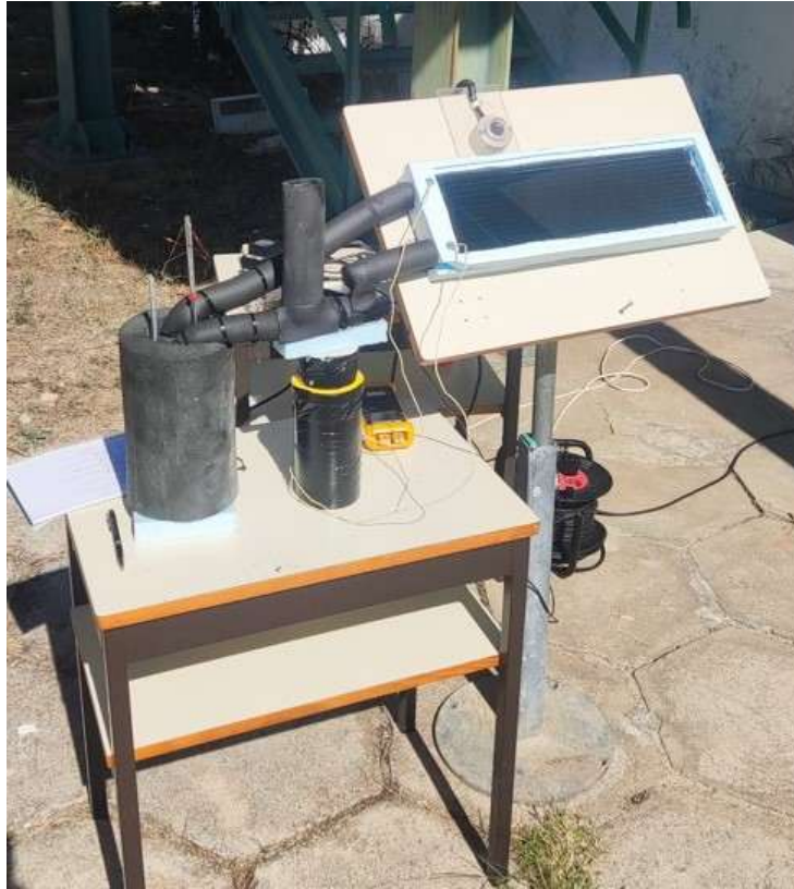
Figura 3.21 – Montagem para ensaio de eficiência do pré-protótipo.
