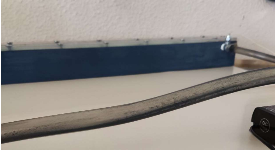
Figura 3.7 – Perda de homogeneidade do nanofluido.
