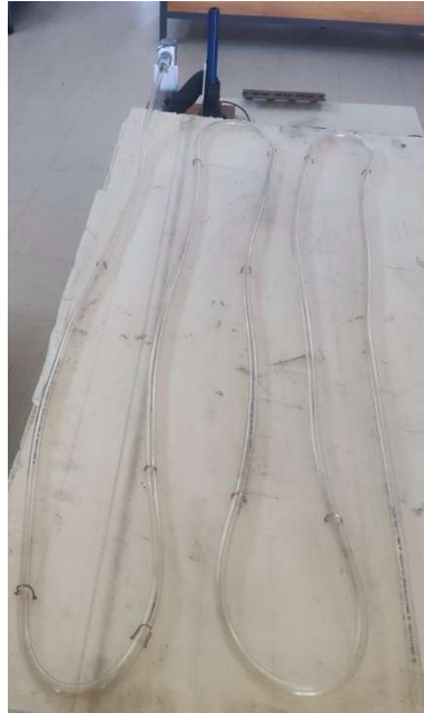
Figura 3.12 – Coletor solar em mangueira de PVC.
