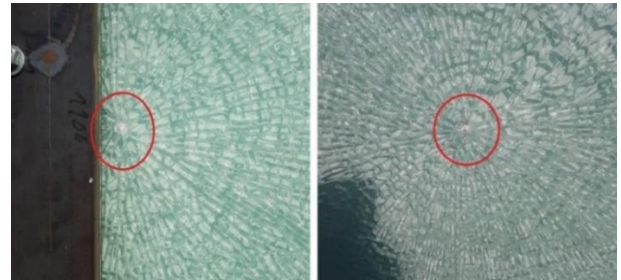
Figura 10 - Padrão de rotura do vidro com impacto de projéteis
