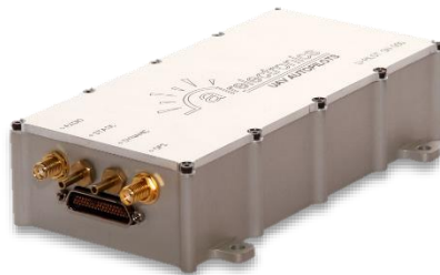
Figura 5-4 - Hardware do piloto automático U Pilot (Extraído de (Airelectronics UAV Autopilots, 2016)).
