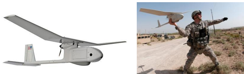
Figura 3-1 - AeroVironment RQ-11B Raven (esquerda) e um militar do Exército dos Estados Unidos em campanha a lançar a aeronave (direita) (Extraído de (AeroVironment, 2017)).
