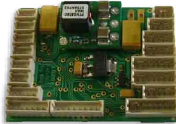
Figura 5-1 - Hardware do piloto automático Paparazzi - Tiny 13 (Extraído de (HaiYang et al. , 2010), “Fig.8”).
