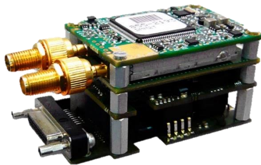
Figura 5-5 - Hardware do Piloto Automático Veronte (Extraído de (Embention, 2016)).
