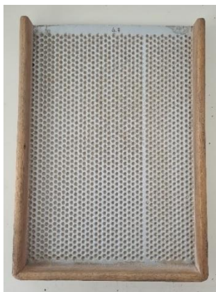
Figura 21- Crivo utilizado para retirar a trinca.
