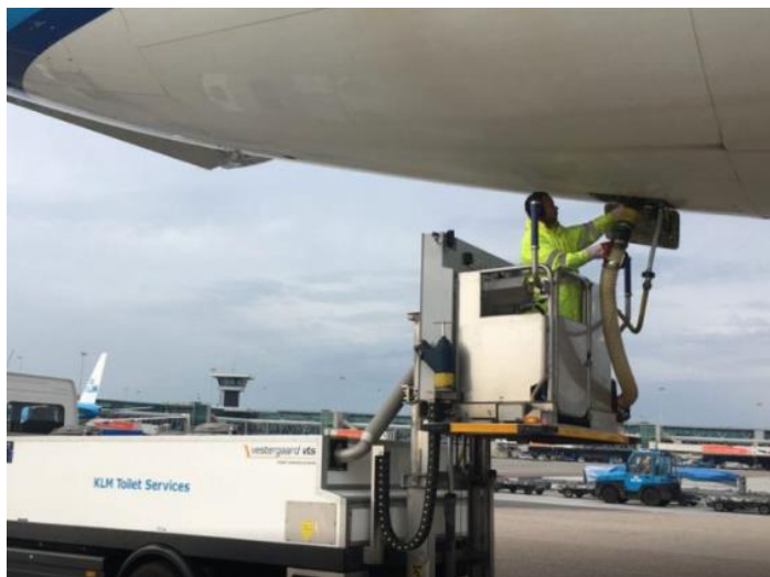
Figura 26 - Remoção de resíduos sanitários
