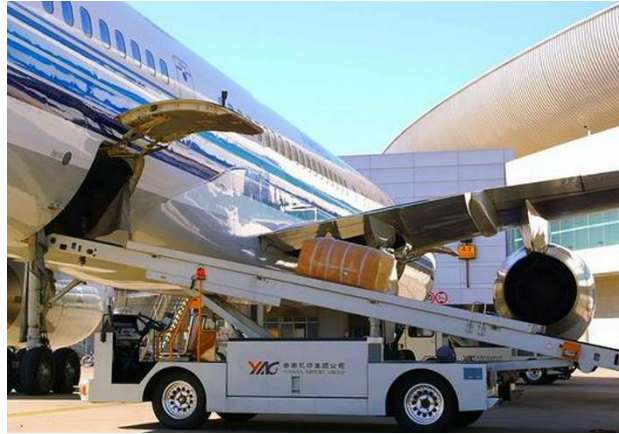
Figura 24 - Belt (Tapete de transporte de bagagens) Fonte: Aviaexpo, 2025
