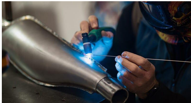
Figura 2.6 - Soldadura TIG (Ronch, 2024).
