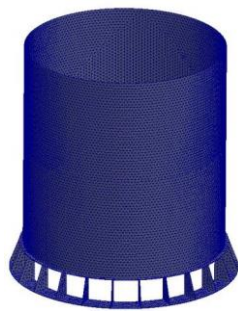
Figura 3.22 - Análise chapa 6 mm sem viga (malha 100 mm).
