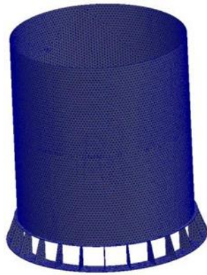
Figura 3.25 - Análise chapa 4 mm sem viga (malha 100mm).
