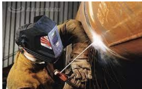
Figura 2.7 - Soldadura eléctrodo revestido (Novotecnica, 2016).
