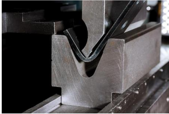
Figura 2.3 - Dobragem com prensa hidráulica (Freepik, 2009).
