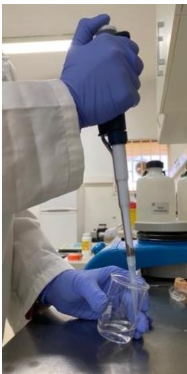
Figura 31 - Figura que ilustra a colocação dos 0,25 ml do Catalisador no copo de ensaio onde já se encontravam os 5 ml do Metilmetacrilato.
