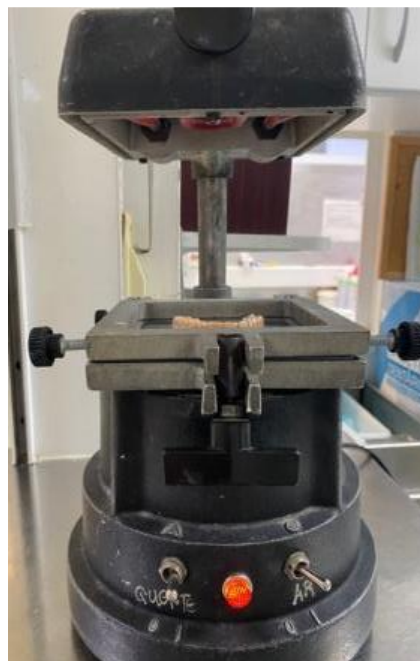
Figura 10 - Máquina DENTAFLUX-The thermoforming machine com o botão de “vácuo” acionado e com o plástico sobre o modelo.
