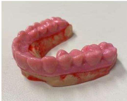
Figura 39 - Alinhador com tonalidade rosa opaco, tornando-se inviável para a medição da intensidade da cor da resina.
