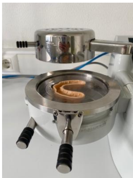
Figura 23 - Máquina SCHEU-Ministar com o alinhador termoformado sobre o modelo.
