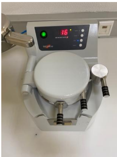
Figura 22 - Máquina SCHEU-Ministar com o plástico aquecido sobre o modelo.
