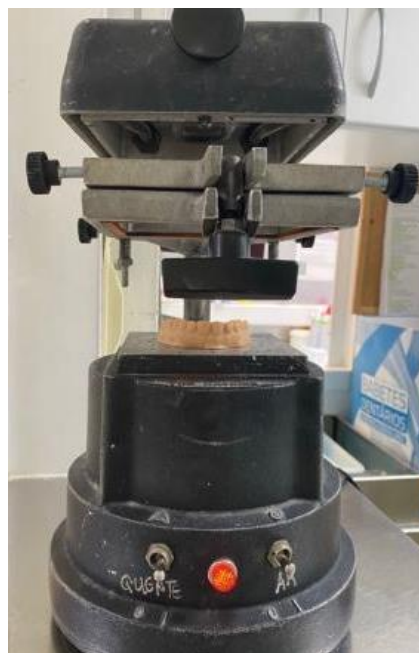
Figura 8 - Máquina DENTAFLUX-The thermoforming machine com o plástico colocado na estrutura da máquina, o modelo na placa base.
