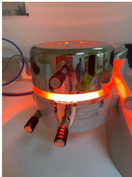
Figura 21 - Máquina SCHEU-Ministar com o elemento de aquecimento sobre o plástico.
