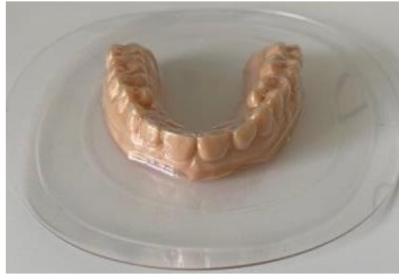
Figura 24 - Alinhador termoformado a pressão retirado da estrutura da máquina.
