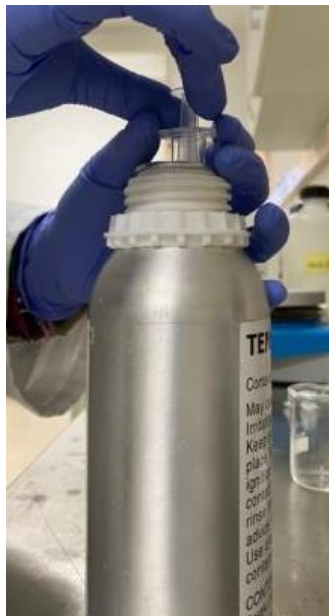
Figura 29 - Figura que ilustra os 5 ml de Metacrilato a serem retirados com recurso a uma seringa de 5 ml.
