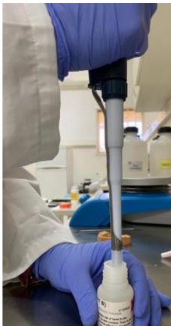
Figura 30 - Figura que ilustra os 0,25 ml de Catalisador a serem retirados com recurso a uma pipeta de 1000 \mu l.
