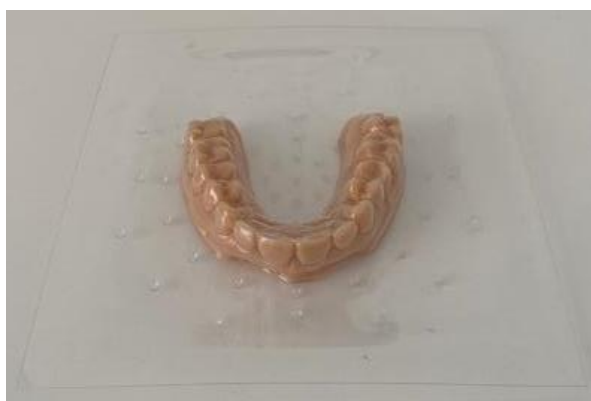
Figura 12 - Alinhador termoformado a vácuo retirado da estrutura da máquina.
