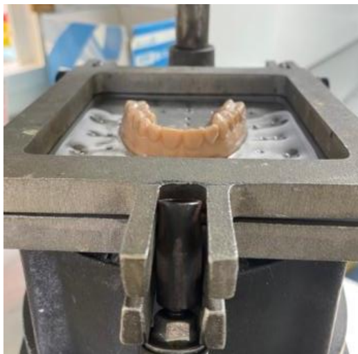
Figura 11 - Máquina DENTAFLUX-The thermoforming machine com a opção de vácuo ligada até que o alinhador já formado arrefeça.
