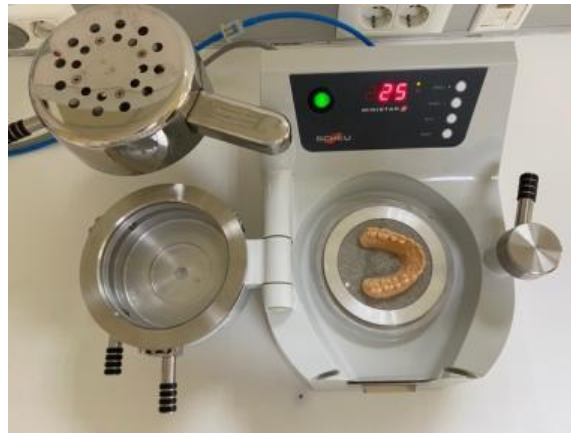
Figura 20 - Máquina SCHEU-Ministar com o plástico colocado na estrutura da máquina, o modelo na placa base e com o tempo de aquecimento introduzido consoante o código fornecido pelo fabricante (Código Biostar : 113).
