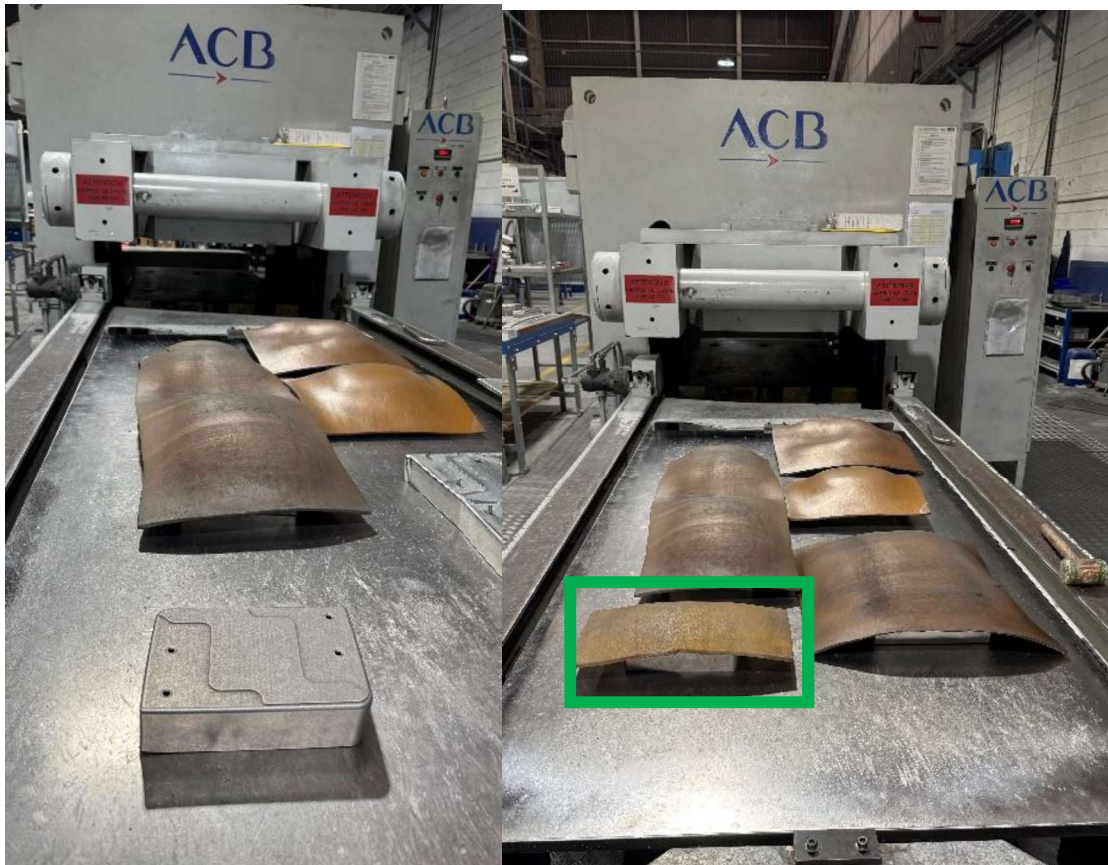
Figura 5.1717 – Ferramenta na prensa de borracha pronta para estampagem.
