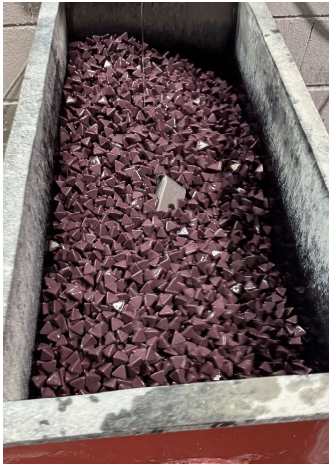
Figura 5.88 – Pós-tratamento de superfície por pedras vibratórias.
