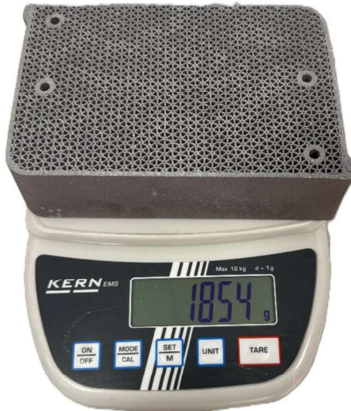
Figura 5.1616 – Verificação da massa da ferramenta.
