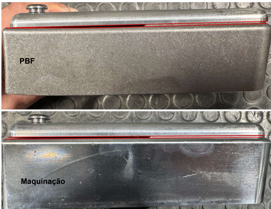
Figura 5.1212 – Deformação em forma de U da parte superior da ferramenta.
