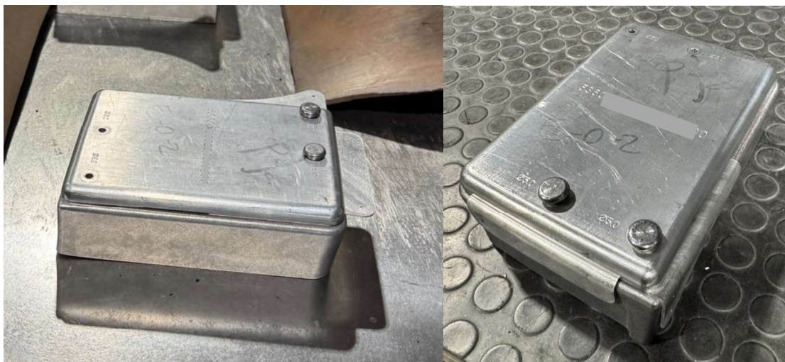
Figura 5.1818 – Peça posicionada para moldagem e peça moldada na ferramenta.
