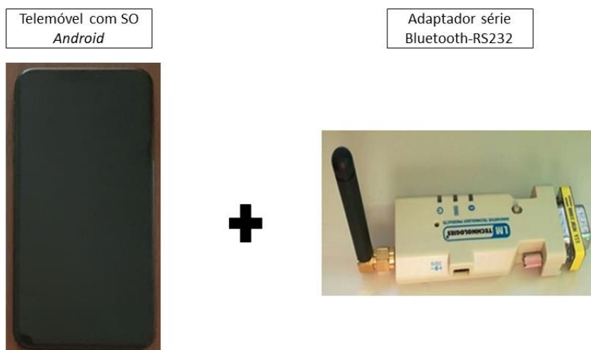
Figura 4.21 - Hardware da interface telemóvel.
