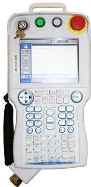
Figura 2.7 - Consola de programação do Motoman DX100. [12]
