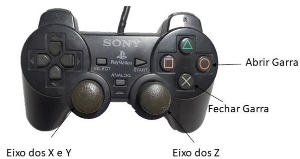
Figura 4.30 - Caracterização da função dos seus manipuladores e botões do joystick.
