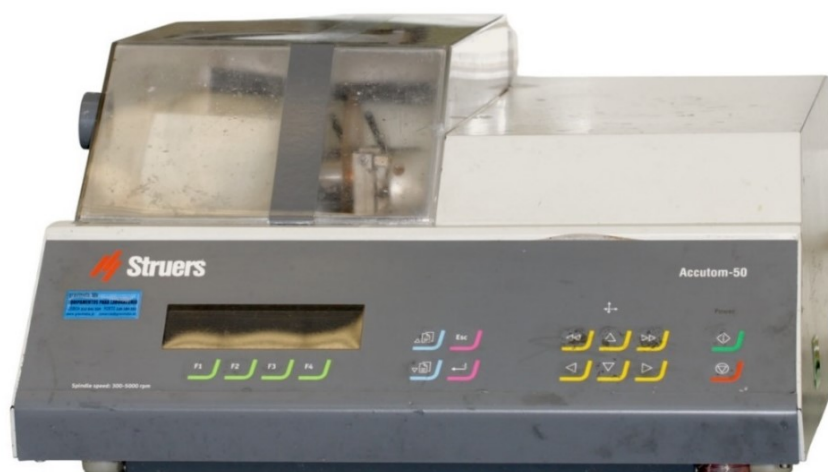
Figura 5. Micrótomo de tecidos duros - Accutom-50 (Struers, Ballerup, Denmark).
