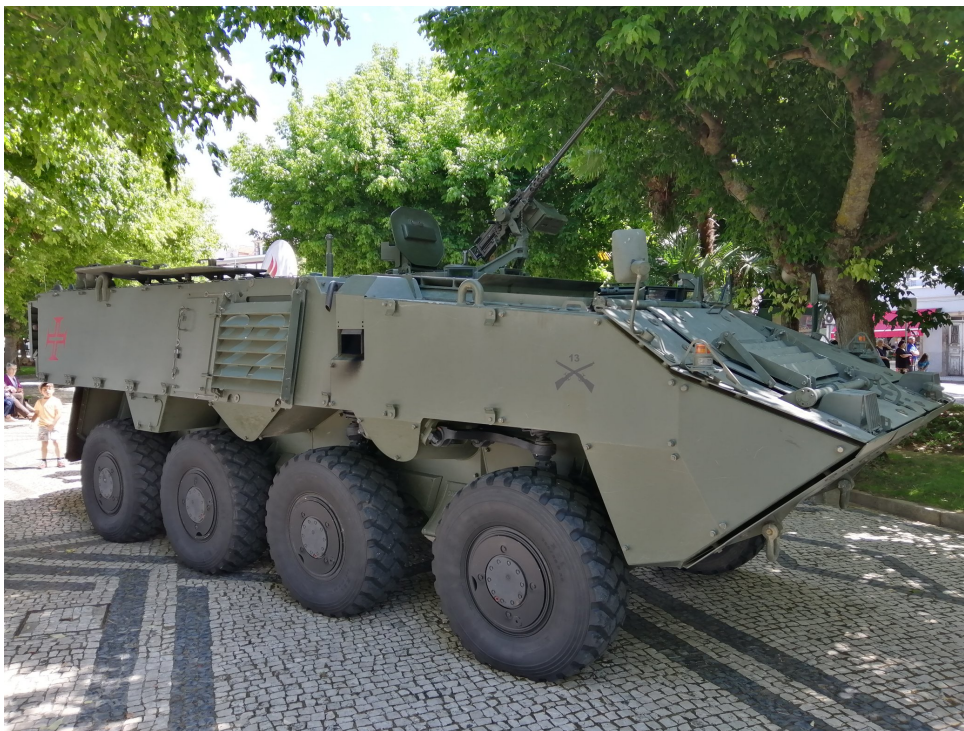
Figura 3.1: Viatura Blindada de Rodas Pandur II 8x8, na versão ICV ao serviço do Exército Português.
