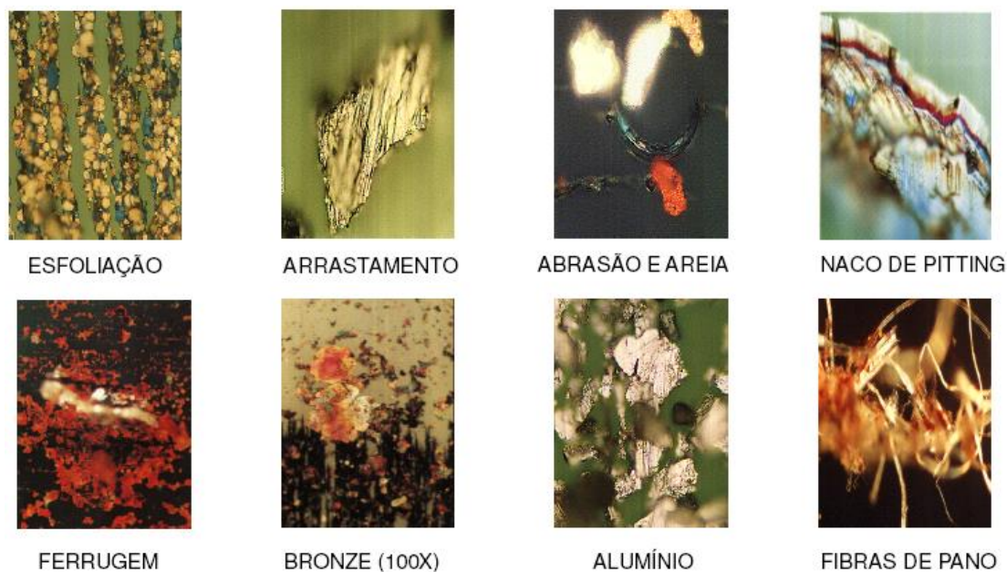
FIGURA 38 IDENTIFICAÇÃO DAS PARTÍCULAS DE DESGASTE
