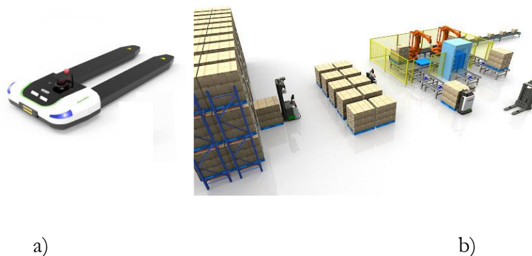
Figura 2.15 – Robôs de garfos: a) Robô de garfos tipo porta paletes; b) Exemplo da utilização dos tipos de robôs de garfos.
