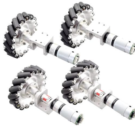
Figura 3.44 – Exemplo do tipo de roda Mecanum utilizada.
