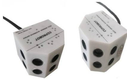
Figura 2.21 – Sensor ultrassónico para evitar obstáculos.
