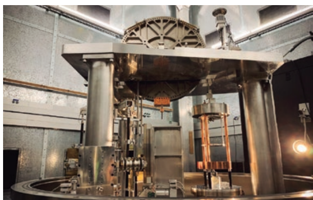
Figura 2. Exemplo de balança Kibble, usada na realização do quilograma do SI (cortesia do NIST).
