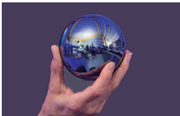
Figura 3. Exemplo de cristal de ^{28}\text{Si} de elevada pureza isotópica de 99,9995 %, em forma de esfera quase perfeita, usada na realização da mole do SI (cortesia do NIST).
