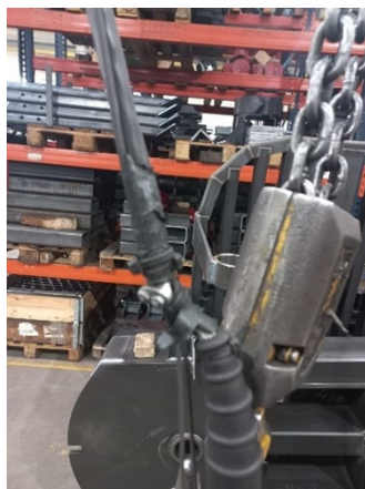
Figura 5.11: Cabo de suporte do comando de controlo, Fonte: ISQ
