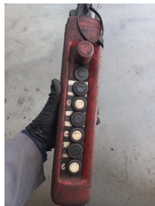
Figura 5.5: Comando de controlo, Fonte: ISQ
