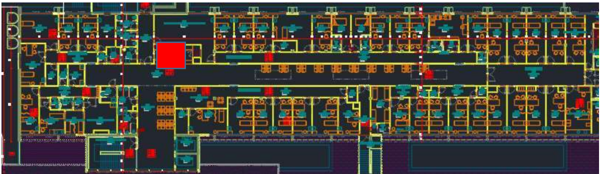
Figura 6. 25 – Localização do início do incêndio – Planta do piso 2
