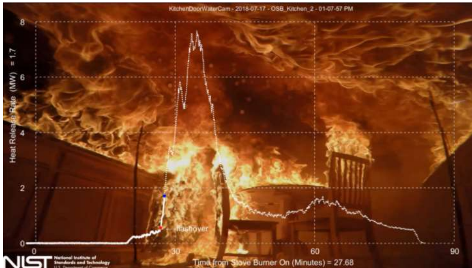
Figura 3. 8 – Flashover numa cozinha – Ensaio (NIST, 2010)
