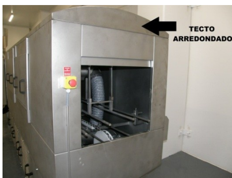
Figura 37-Tecto em equipamento antigo
