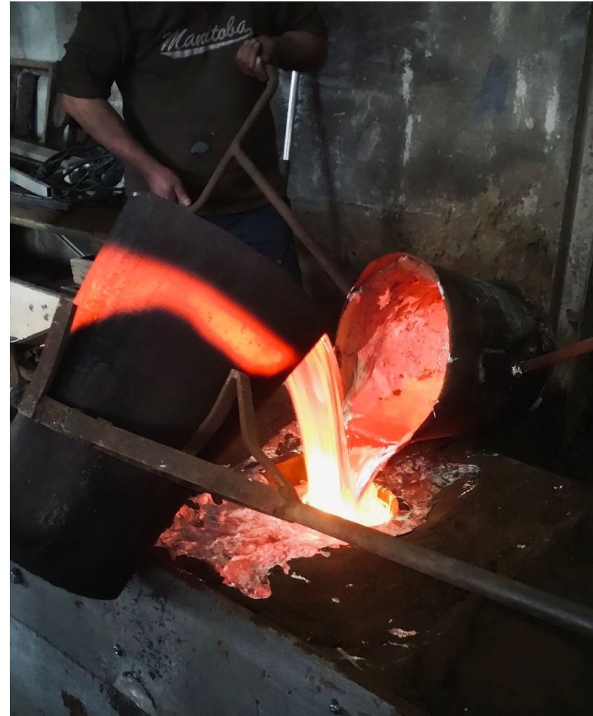
Imagem 18 - Ferro fundido a ser vertido para o molde
