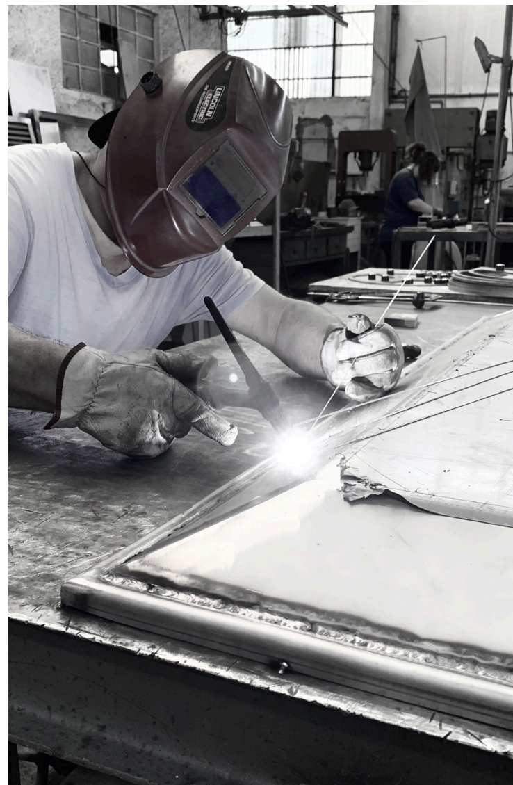
Imagem 73 - Processo de soldadura da cantoneira
