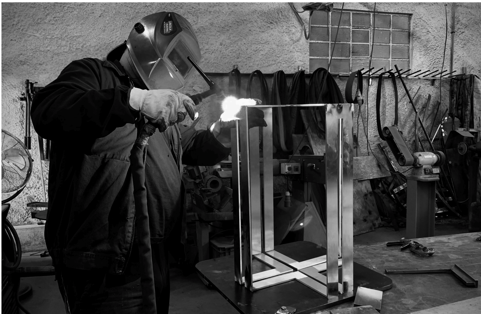
Imagem 30 - Soldadura duma das mesas
