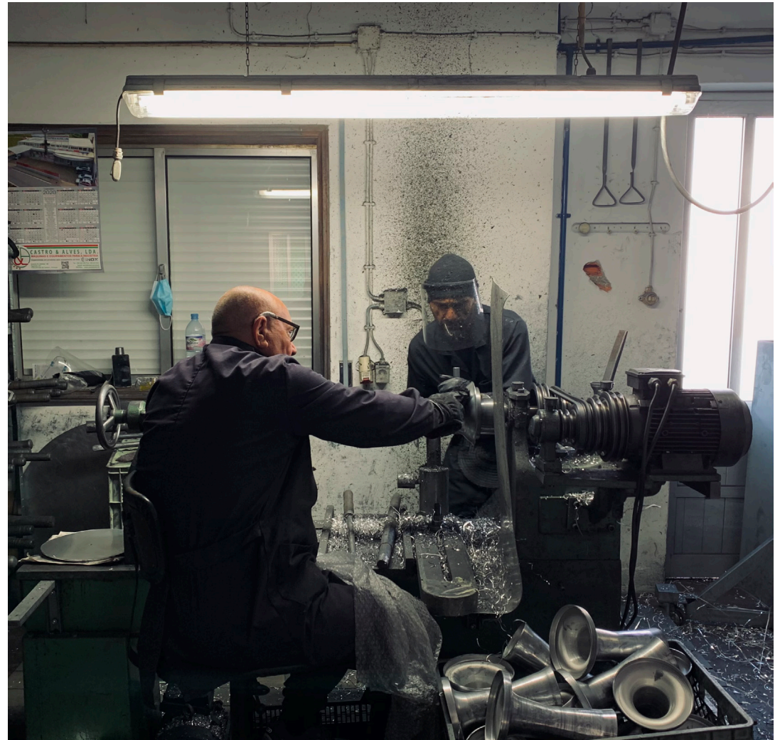
Imagem 3 - Repuxagem de uma chapa de alumínio
