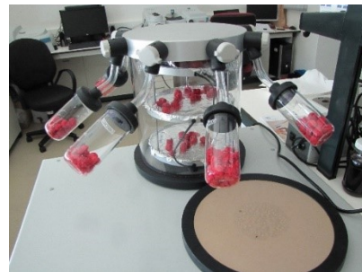
Figura 23.4: Câmara de vácuo com o respetivo material congelado nos copos ligados pela válvula de vácuo
