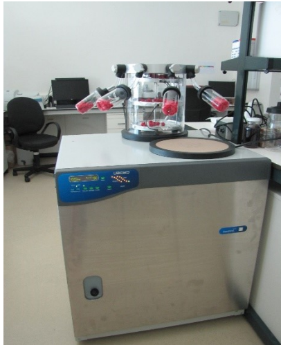
Figura 21: Liofilizador usado no estudo das secagens
