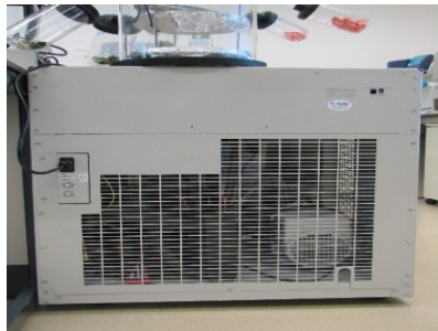
Figura 23.3: Parte de trás do liofilizador onde se vê a bomba de vácuo
