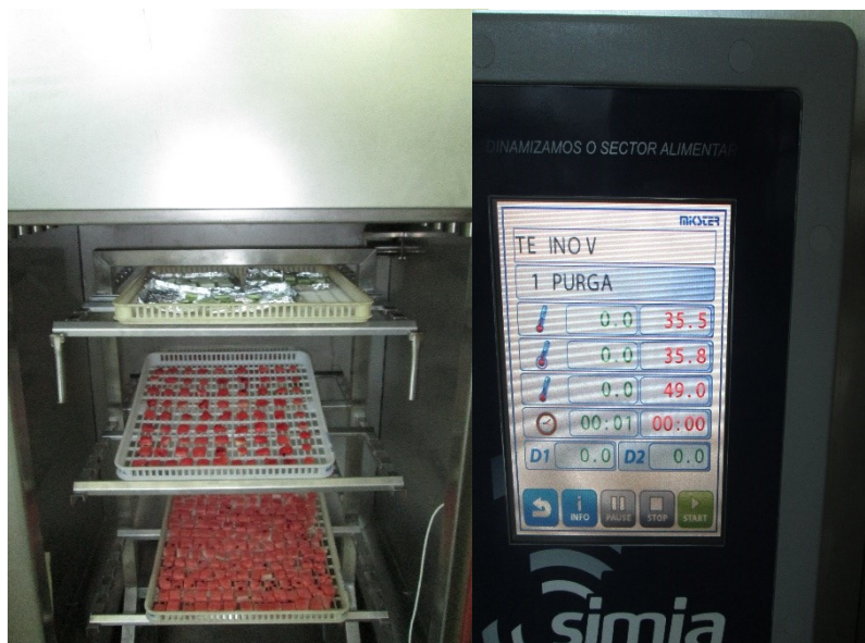
Figura 25: Câmara da estufa industrial à esquerda e painel de controlo à direita
