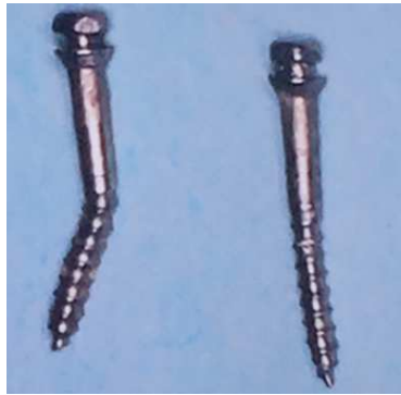
Figura 28. Aplicação de força demasiado longe da interface osso/MI, resultando em deformação do MI. Imagem retirada de (Brunetto et al., 2017).
