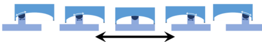
Figura 22 - Diferentes fases do movimento do apoio FPB sujeito a ações sísmicas horizontais [11]
