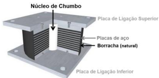
Figura 18 - Constituição de um apoio LRB. Adaptado de [40]
