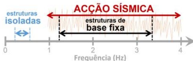
Figura 6 - Enquadramento de frequências comuns de estruturas isoladas e não isoladas (base fixa) no intervalo usual das frequências de excitação sísmica de maior energia [25]
