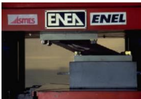
Figura 15 - Deformação horizontal de um apoio HDRB [19]
