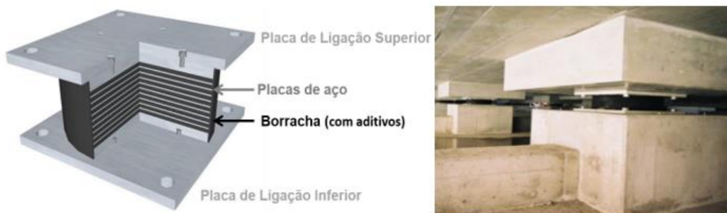
Figura 13 - Constituição do apoio HDRB (à esquerda) [39] e aplicação de apoio HDRB em contexto real (à direita) [40]
