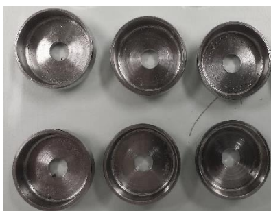
Figura 4 - Formas metálicas utilizadas na preparação dos blocos de acrílico
