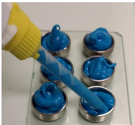
Figura 5 -Preenchimento das formas metálicas com silicone Elite® HD+ light body normal set (Zhermack® Clinical – Badia Polesine, Itália)
