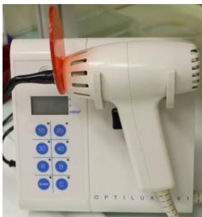
Figura 7 - Fotopolimerizador Optilux 501 (Kerr, Middleton, USA)
