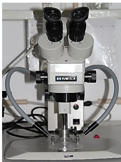
Figura 11 - Estereomicroscópio Meiji Techno EMZ – 8TR (Meiji Techno Co. – Saitama, Japão)
