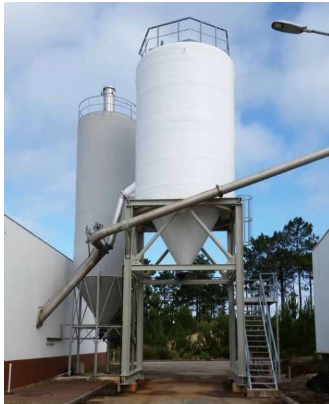
Figura 12. Silo de armazenamento de lama desidratada. Fonte: Google imagens (2023)
