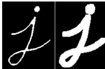
FIGURA 2.5: Dilatação. Retirado de OpenCV Development Team (2025).
