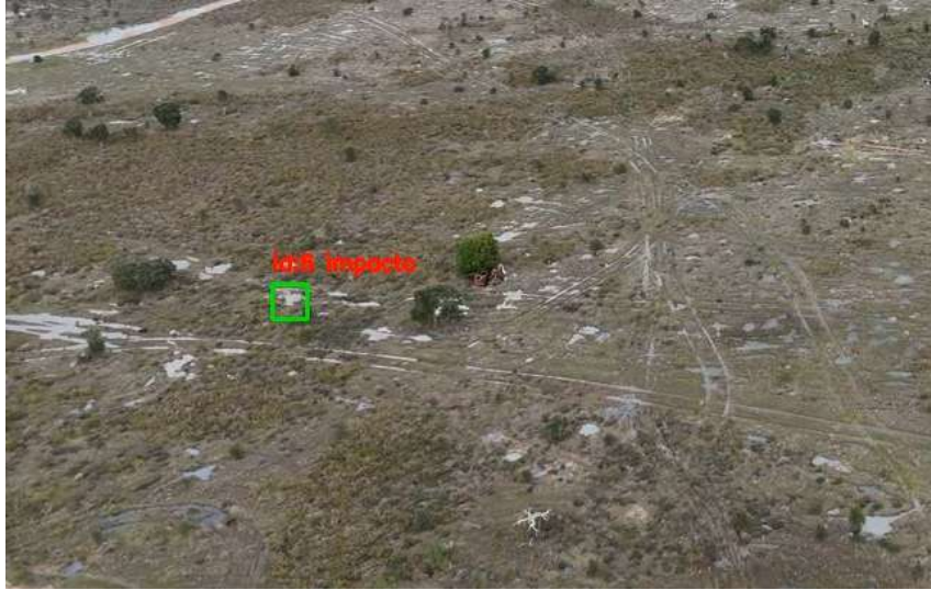
FIGURA 5.7: Falso Positivo. Reflexo de uma poça de água considerada como uma detecção de impacto.
