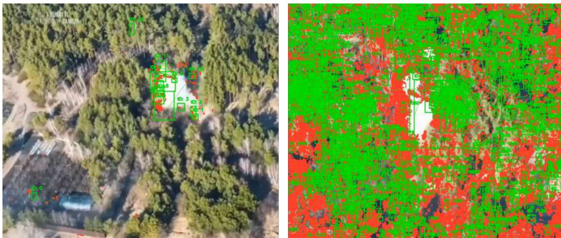
FIGURA 5.9: Exemplo de resultados com o método baseado em GMM: múltiplas falsas detecções e ruído em cenário com movimento.
