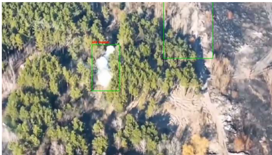
FIGURA 5.10: Exemplo de resultados com o método YOLOv8 : detecção verdadeira e falso positivo no mesmo frame .
