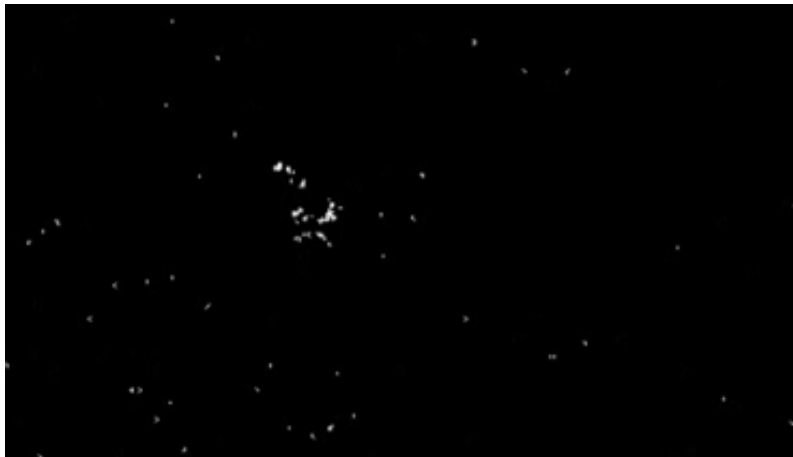
FIGURA 4.4: Máscara binária realizada com Background Subtraction
