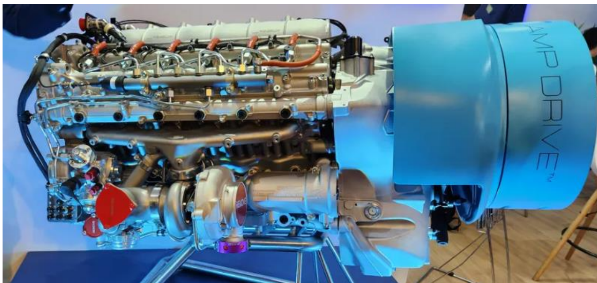
Figura 7: Motor híbrido-elétrico operado pela Azul em parceria com a Ampire para colocar nos Cessna Grand Caravan para rotas regionais
