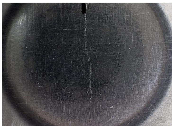
Figura 4.9 Fenda principal em propagação do provete BTM2021_101
