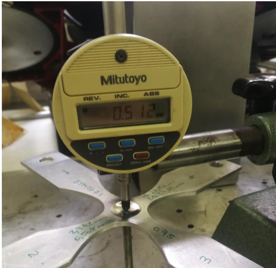
Figura 3.4 Medição da espessura da secção central do provete
