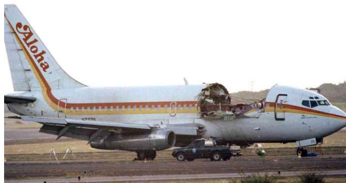
Figura 1.1 Perda da fuselagem do B727-222 [1]
