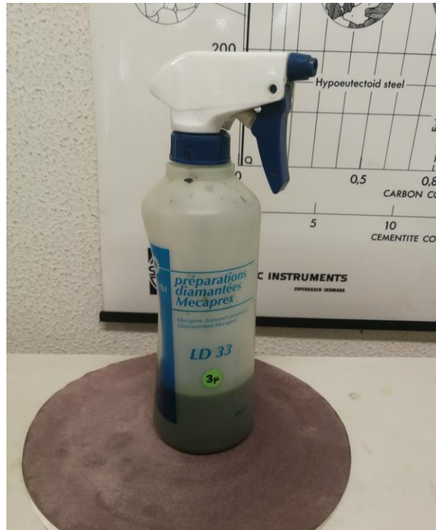
Figura 3.5 Pasta diamante e pano de 3 µm
