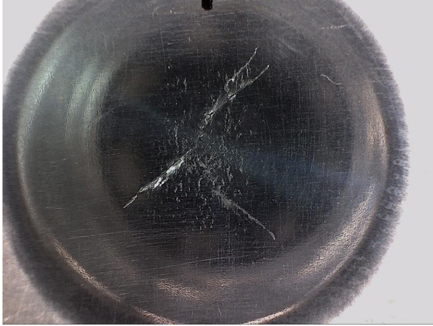
Figura 4.10 Fenda principal com propagação complexa e respectivas microfissuras provete BTM2021_105
