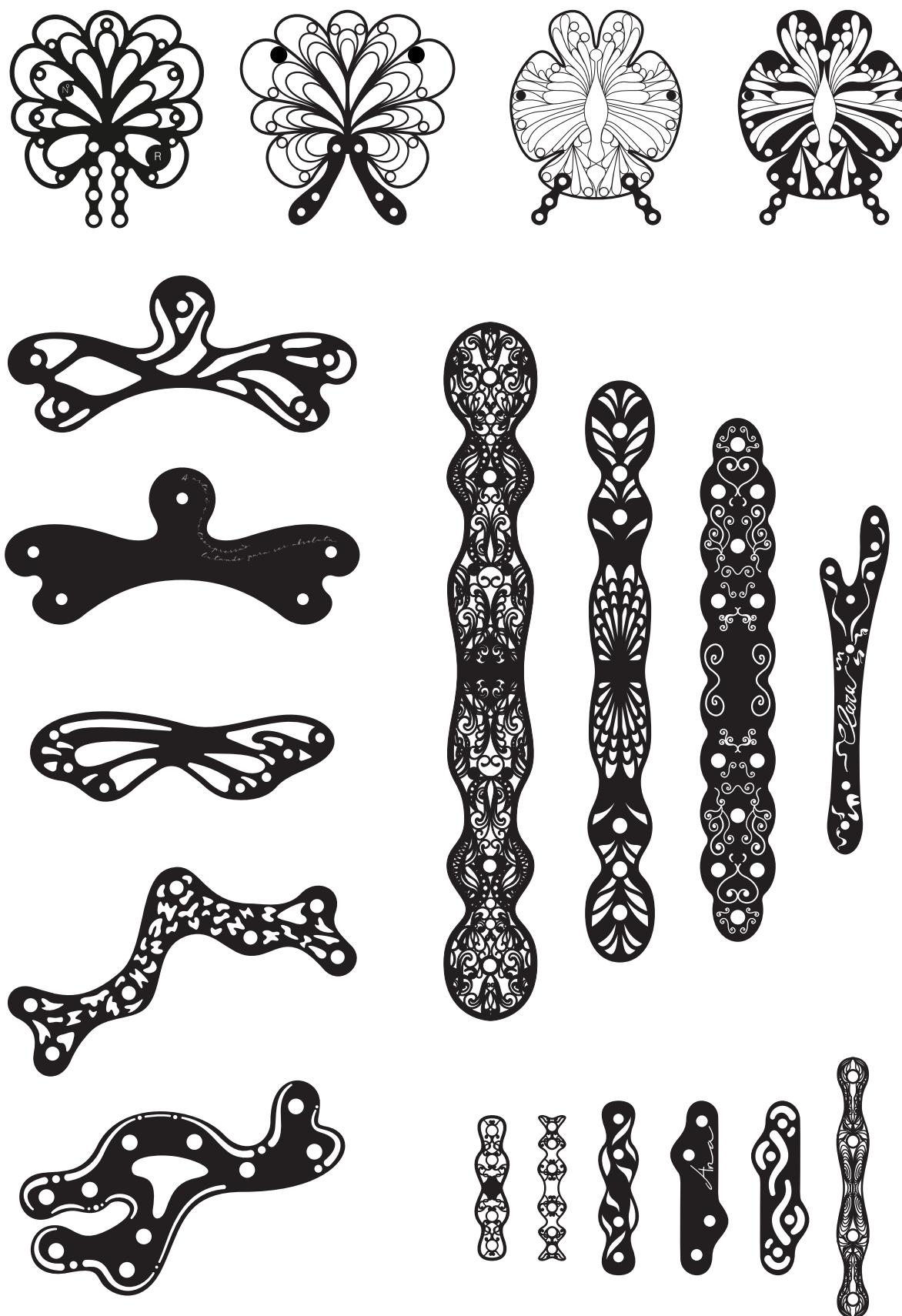
Figura 190. Exemplos de ilustrações vetorizadas de placas de fixação óssea de órbita, falange, calcâneo, cúbito/rádio para corte a laser.
