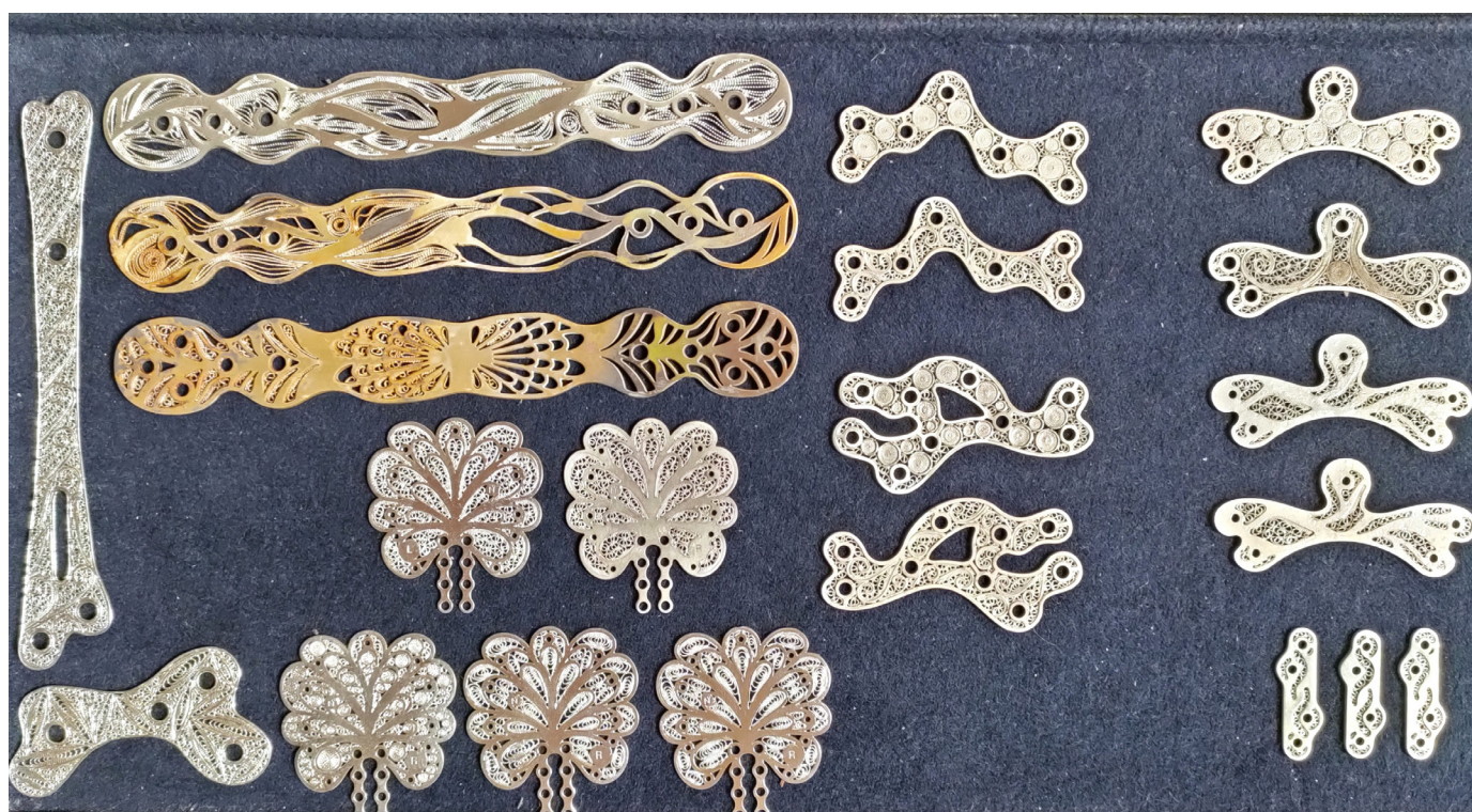
Figura 201. Fotografia das primeiras placas de fixação em Biofiligrana® com enchimento em filigrana de prata.
