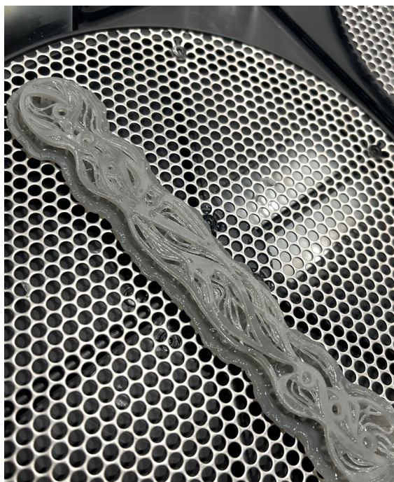
Figura 194. Placa de cúbito 'Waterfall' em 3D durante o processo de cura.
