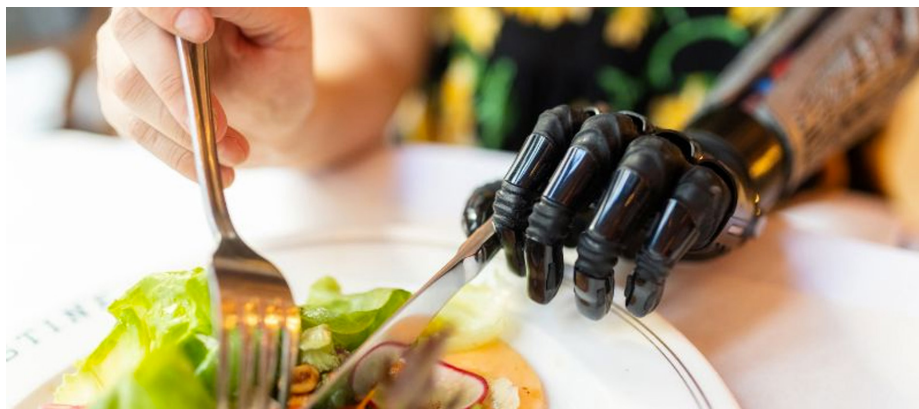
Figura 131. The Nexus Hand, braço biônico, pela empresa COVVI.
