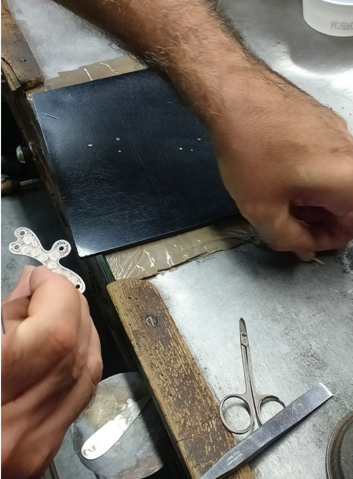
Figura 197. Filigraneiro a dar início ao enchimento de uma placa de osteossíntese de calcâneo em Biofiligrana®.
