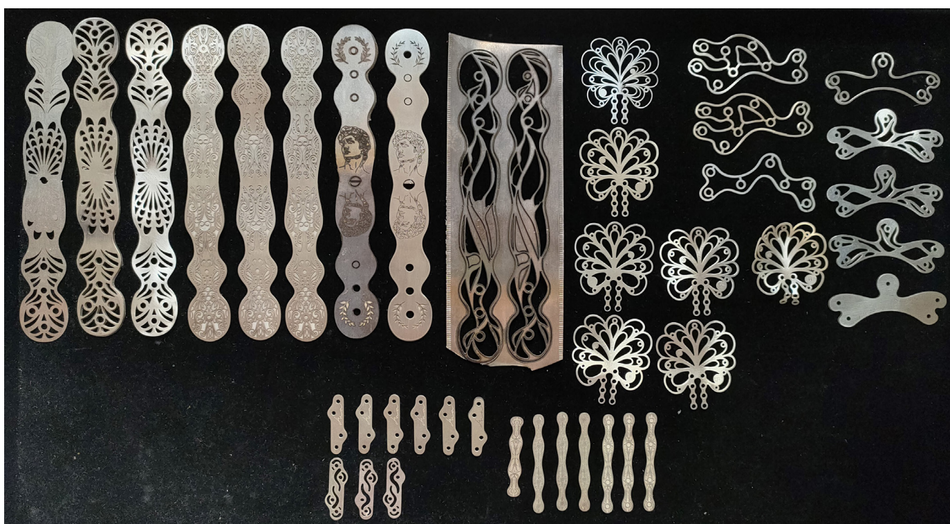
Figura 200. Fotografia das primeiras estruturas cortadas a laser numa chapa de prata, com gravações e sem enchimento.
