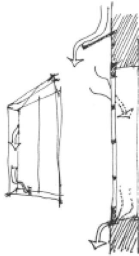
52. Ilustración funcionamiento ventilación ventana
