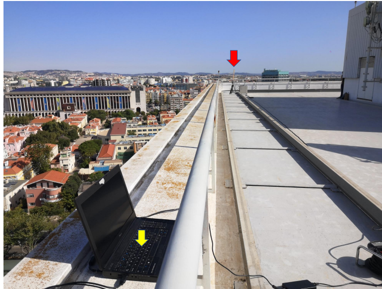
FIGURA 4.9: Cenário dos testes experimentais com o transmissor representado pela seta a amarelo e o recetor representado pela seta a vermelho
