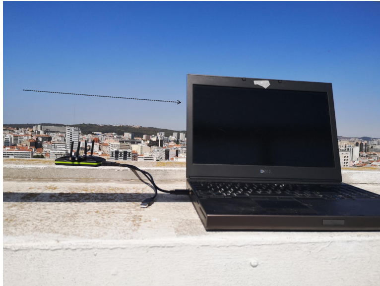
FIGURA 4.10: Transmissor no cenário experimental com a representação da trajetória dos aviões pela seta a tracejado
