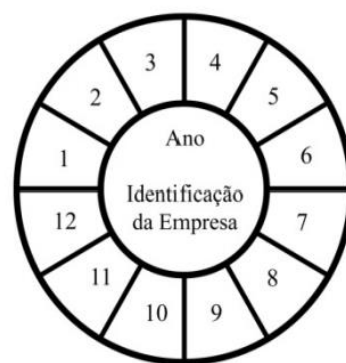
Figura 12 - Exemplo do dístico a incluir na etiqueta de manutenção (NP 4413, 2012)
