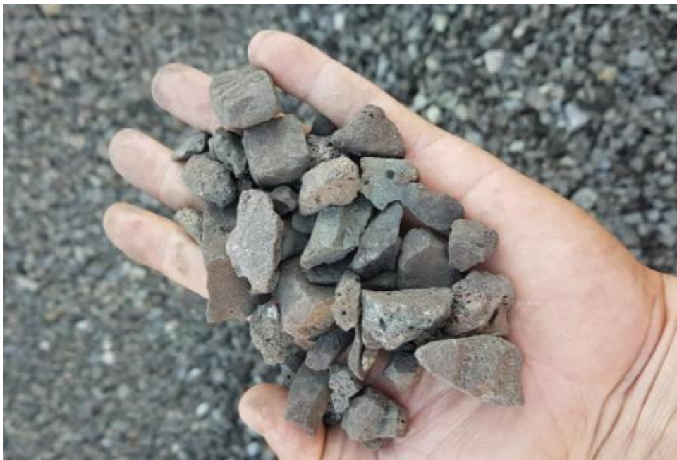
Figura 5 - Escória no estado sólido, ou seja, à temperatura ambiente [28]
